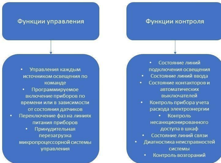
Схема 2. Функции системы адаптивного управления освещением.
