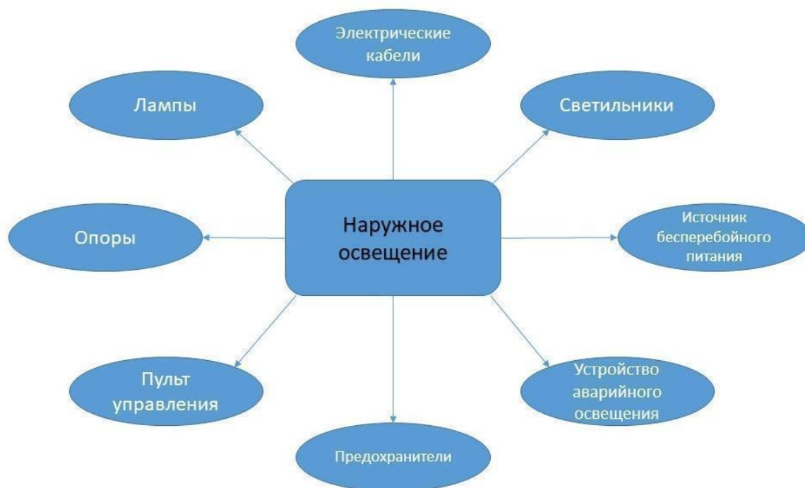
Схема 1. Основные компоненты уличного городского освещения.
