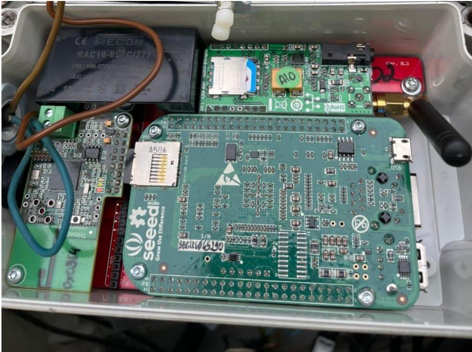
Изображение 5. Модем для подключения щита к электросети.
