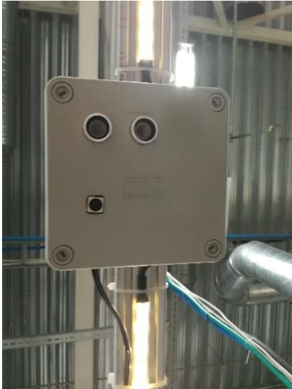
Joonis 1. Raspberry Pi, ultrahelianduri ja kaamera asetsemine harukarbis
