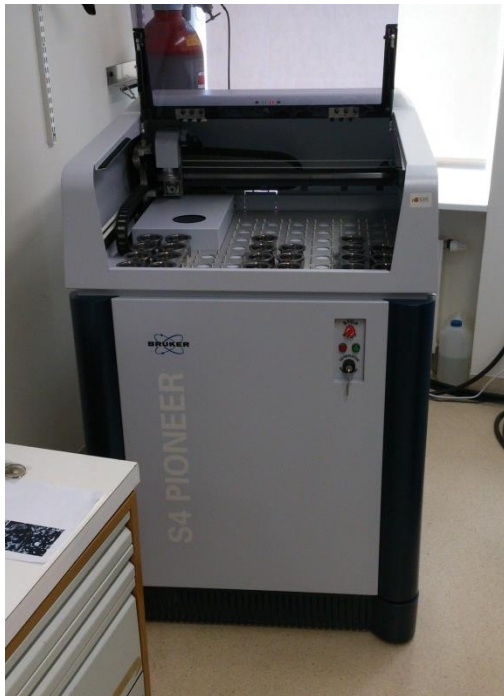
Joonis 5.4 TTÜ Geoloogia Instituudi Bruker S4 Pioneer röntgenfluorestsents spektromeeter
