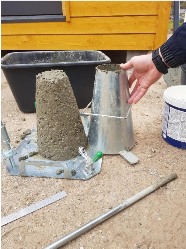
Joonis 3.12 Abramski koonusega segu plastsuse määramine
