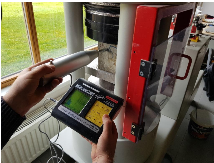
Joonis 3.15 Schmidt'i vasaraga survetugevuse määramine
