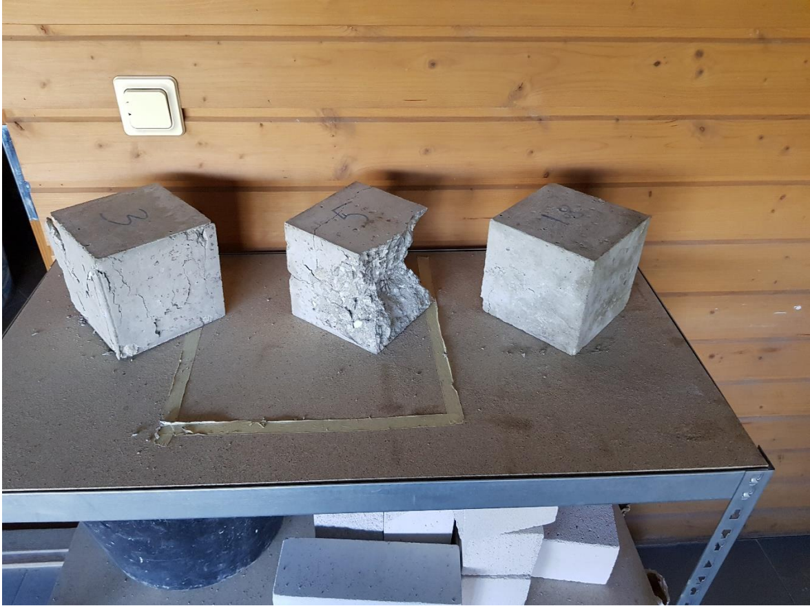
Joonis 3.16 Katsekehade purunemispildid
