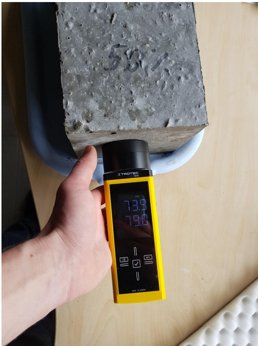
Joonis 3.14 Troteciga niiskuse sisalduse mõõtmine
