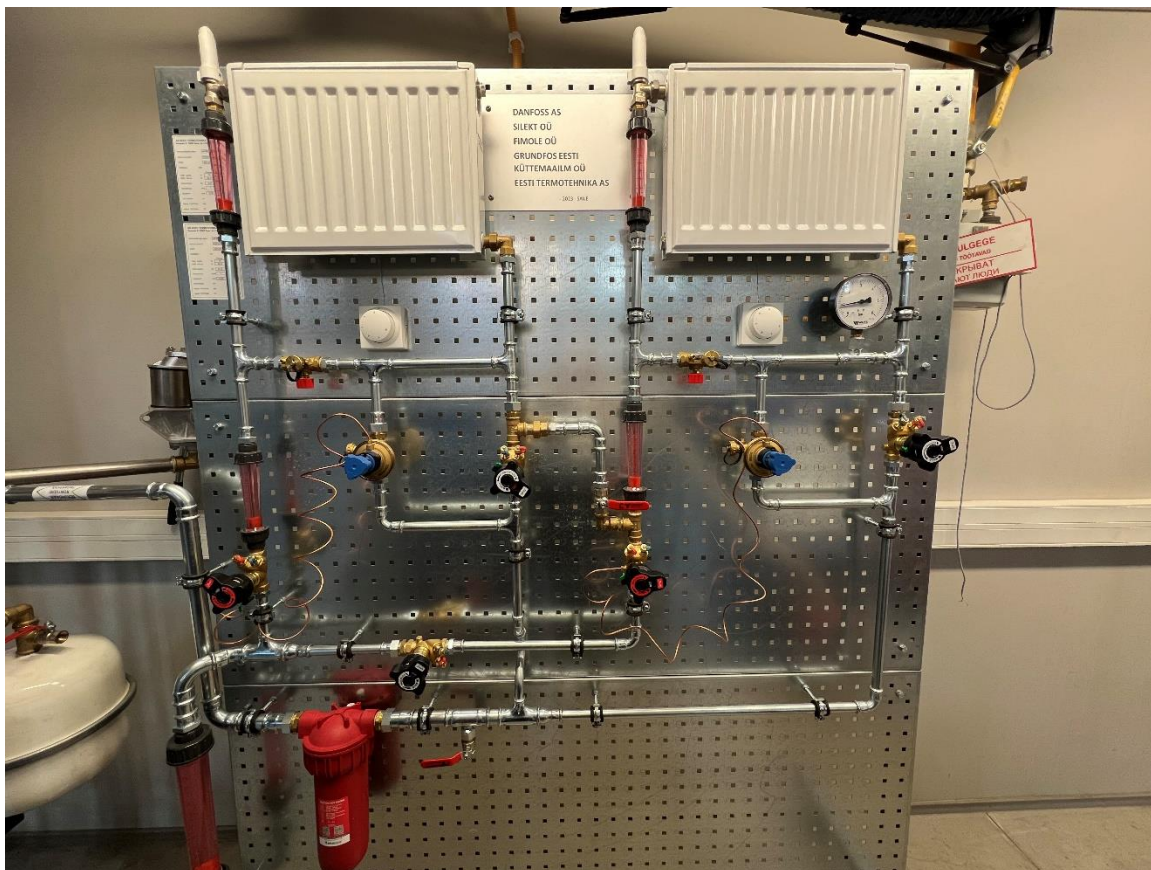
Joonis 1. Tallinna Tehnikaülikooli soojussõlme õpepõhendi kahetoru küttesüsteemi imiteering, autor 2024
