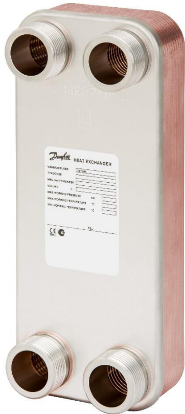
Joonis 4. Stendil kasutatav Micro Plate™-soojusvaheti, XB12M-1, Vask, Plaatide arv: 20, 25 bar [9]
