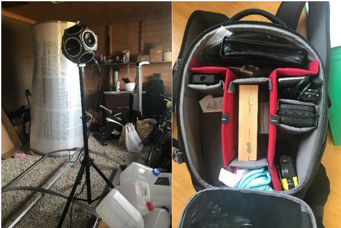
Joonis 3.4.1.4 Heliisolatsiooni mõõtmisel kasutatud kõlar teises positsioonis ja vajalike vahenditega mõõtmistarvete kott
