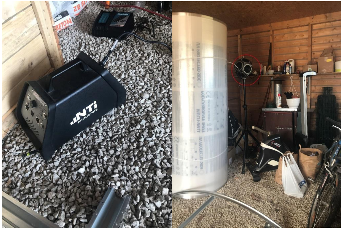
Joonis 3.4.1.3 Heliisolatsiooni mõõtmistel kasutatud võimendi ja kõlar (märgitud punase ringiga) esimeses positsioonis
