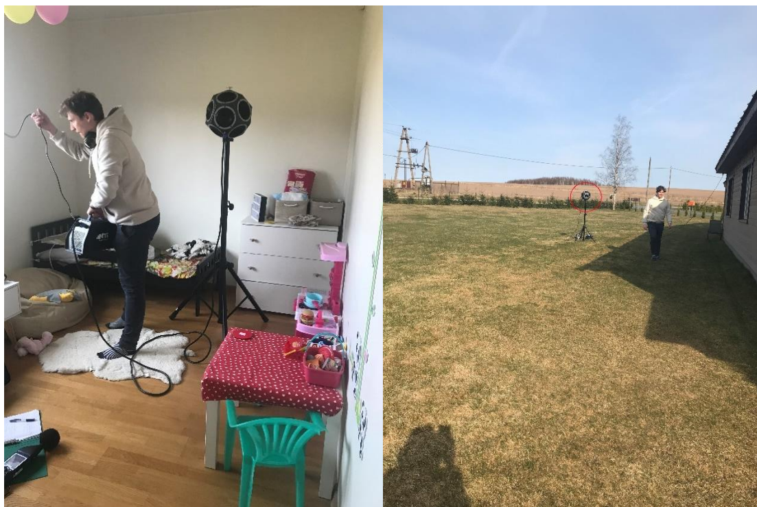
Joonis 3.4.1.5 Ruumi järelkõlastuse mõõtmisel kasutatud kõlar esimeses positsioonis ning fassaadi ja avatäite ühisiolatsioonivõime mõõtmisel kasutatud kõlar (märgitud punase ringiga) väljas esimeses positsioonis
