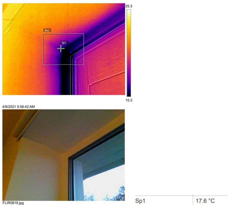
Joonis 2.2.3.8 Vesilinnu tee 6 üksikelamu tuba 1 akna-välisseina ühenduse termopilt ja foto (vt Lisa 1 jooniselt)
