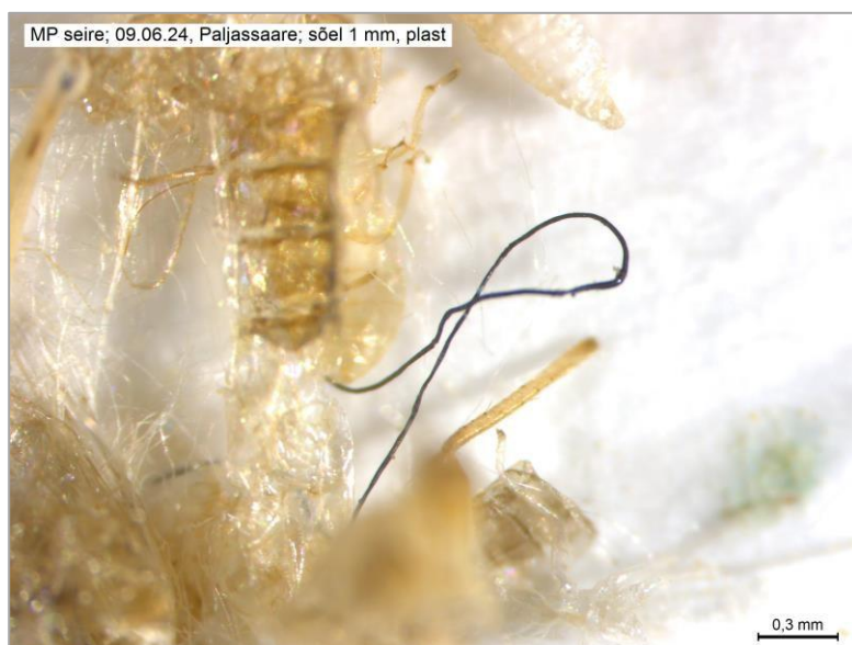
Joonis 5. Plastkiud 2024. aastal võetud Paljassaare piirkonna proovist.
