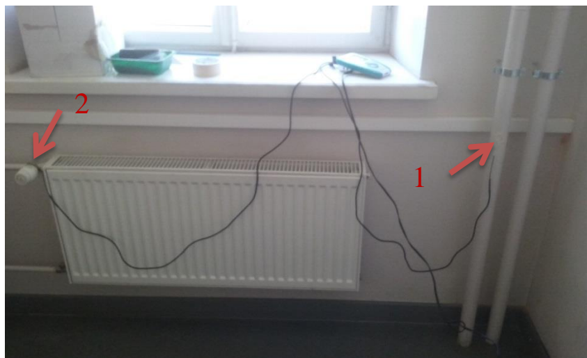
Joonis 3.10. Temperatuuri pinnaandurite asukohad auditooriumis A105
