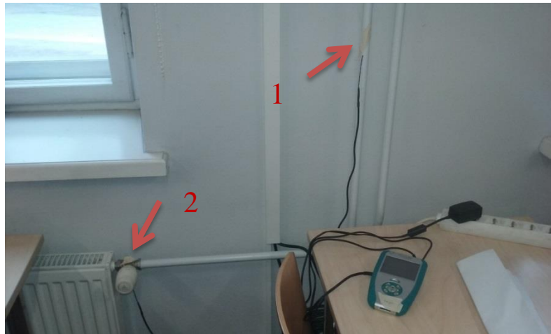
Joonis 3.9. Temperatuuri pinnaandurite asukohad auditooriumis A102
