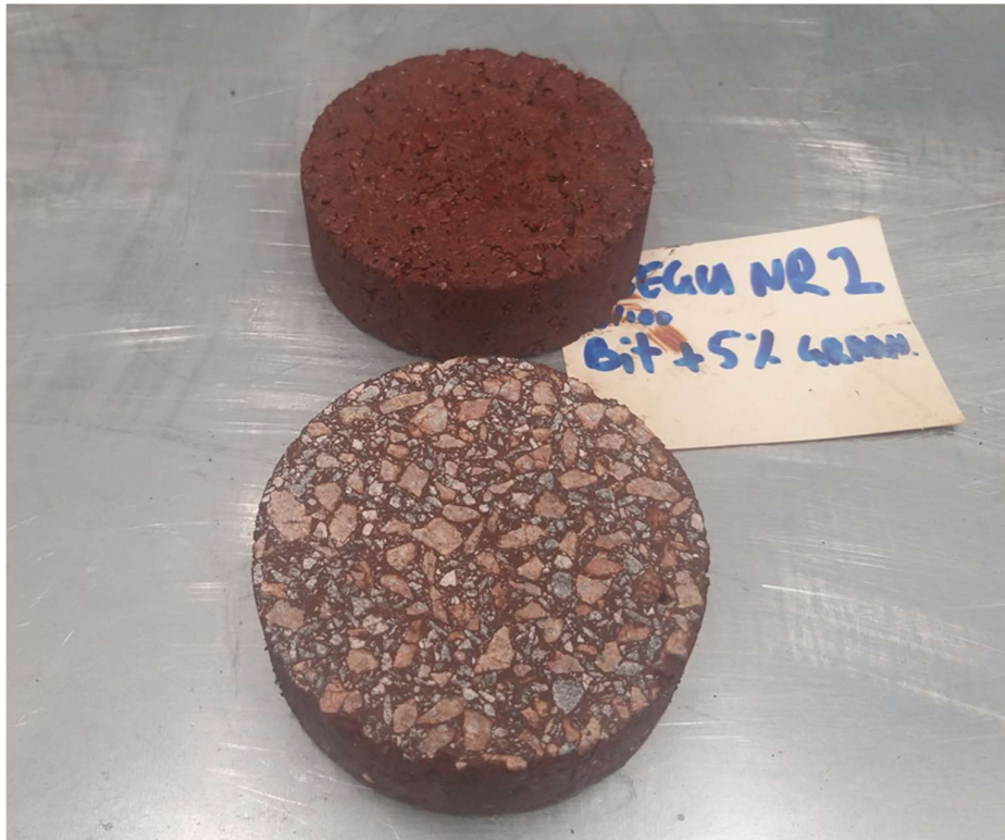
Joonis 3.10. Värvitud musta bituumeniga asfaltsegu [Erakogu]
