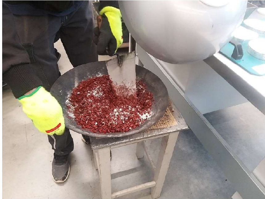
Joonis 3.6. Punase asfaltsegu käsitsi segamine [Erakogu]
