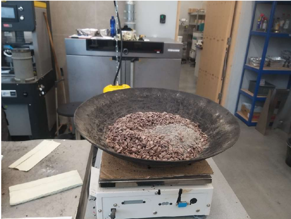
Joonis 3.3. Täitematerjal enne bituumeni lisamist ja käsisegu valmistamist [Erakogu]
