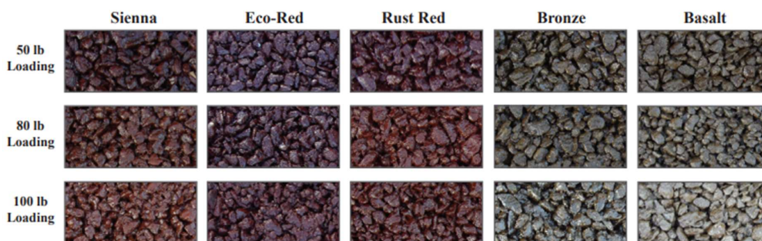
Joonis 2.1. Võimalikud saadavad asfalti värvitoonid kasutades tavapärasest musta bituumenit ja Asphalt Color pigmenti. 50lb≈22,5kg [39]
