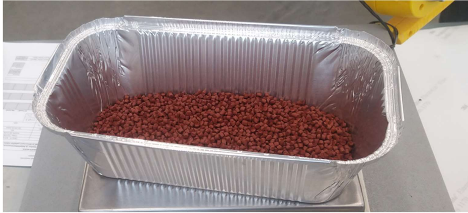
Joonis 3.4. asfaltsegudes kasutatud pigment graanuli kujul [Erakogu]
