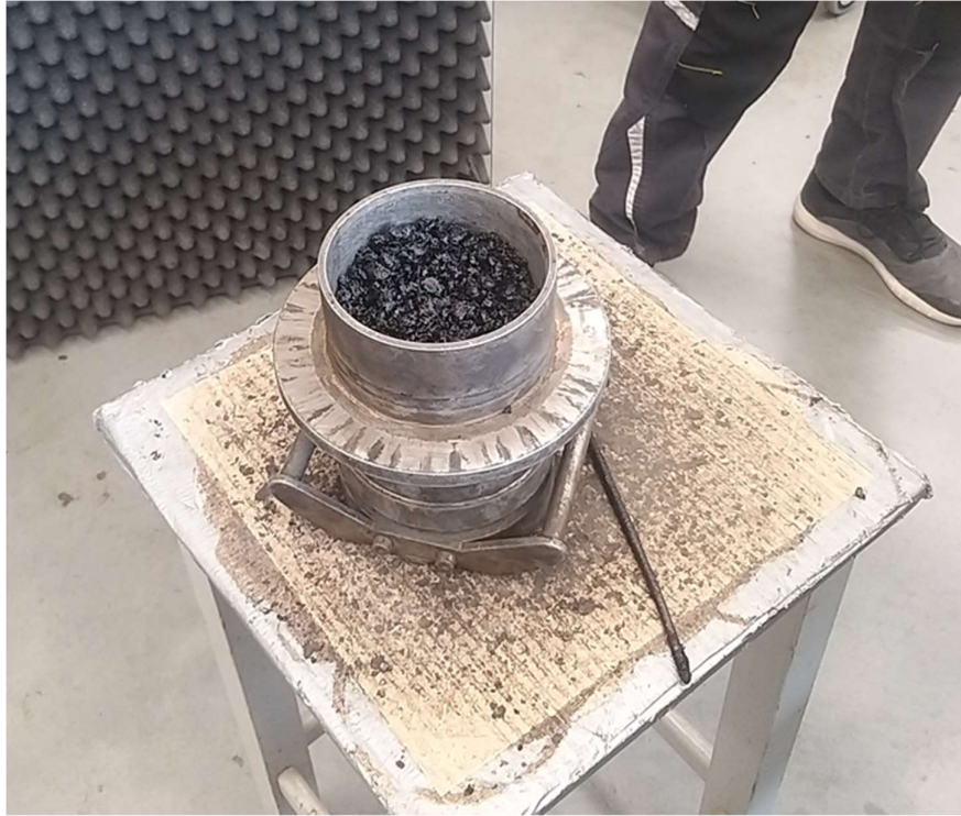
Joonis 3.7. Marshalli tihendamismvorm koos asfaltseguga enne tihendamist [Erakogu]
