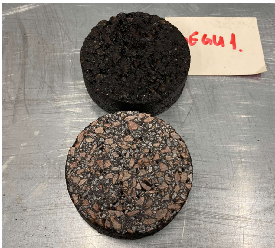
Joonis 3.8. Musta bituumeniga asfaltsegu [Erakogu]
