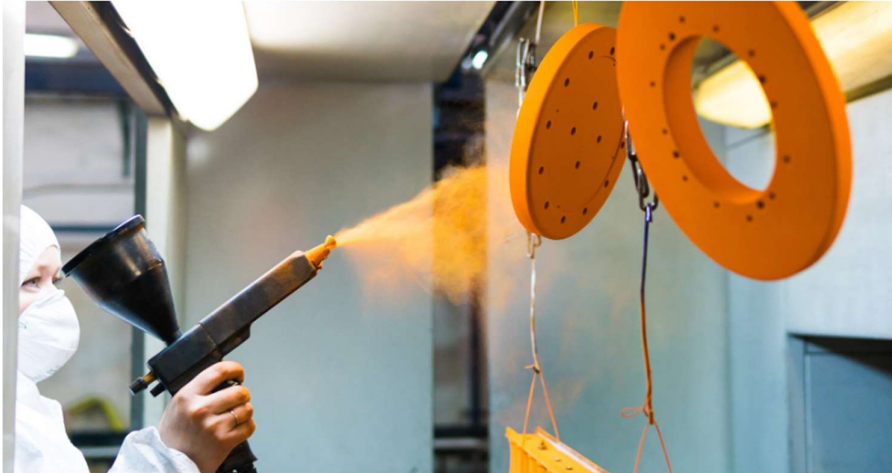
Joonis 1.5. Polüestervärviga detailide katmine [25]
