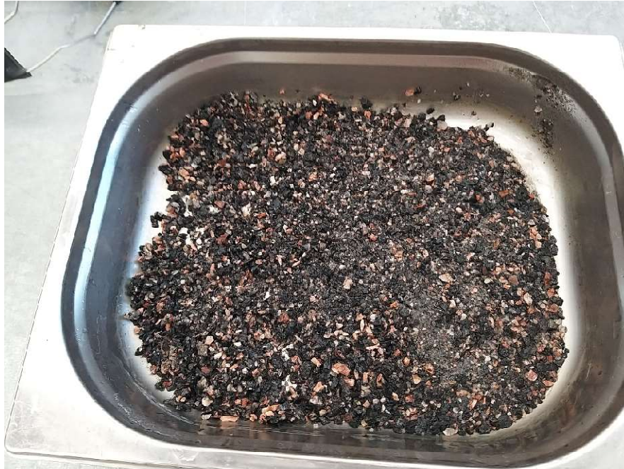
Joonis 3.14. Asfaltsegudes kasutatud Inkoo sõelmed pestud kujul [Erakogu]
