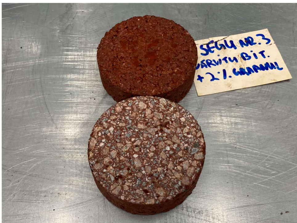
Joonis 3.12. Värvitud läbipaistva sideainega asfaltsegu [Erakogu]
