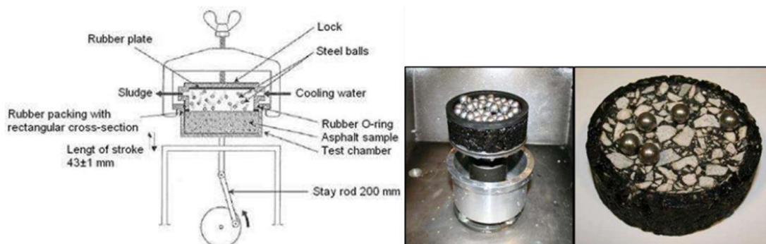
Joonis 2.3. Pralli aparaat (joonis võetud EN 12697-16:2004, pilt on tehtud Brynhild Snilsbergi poolt) [46]
