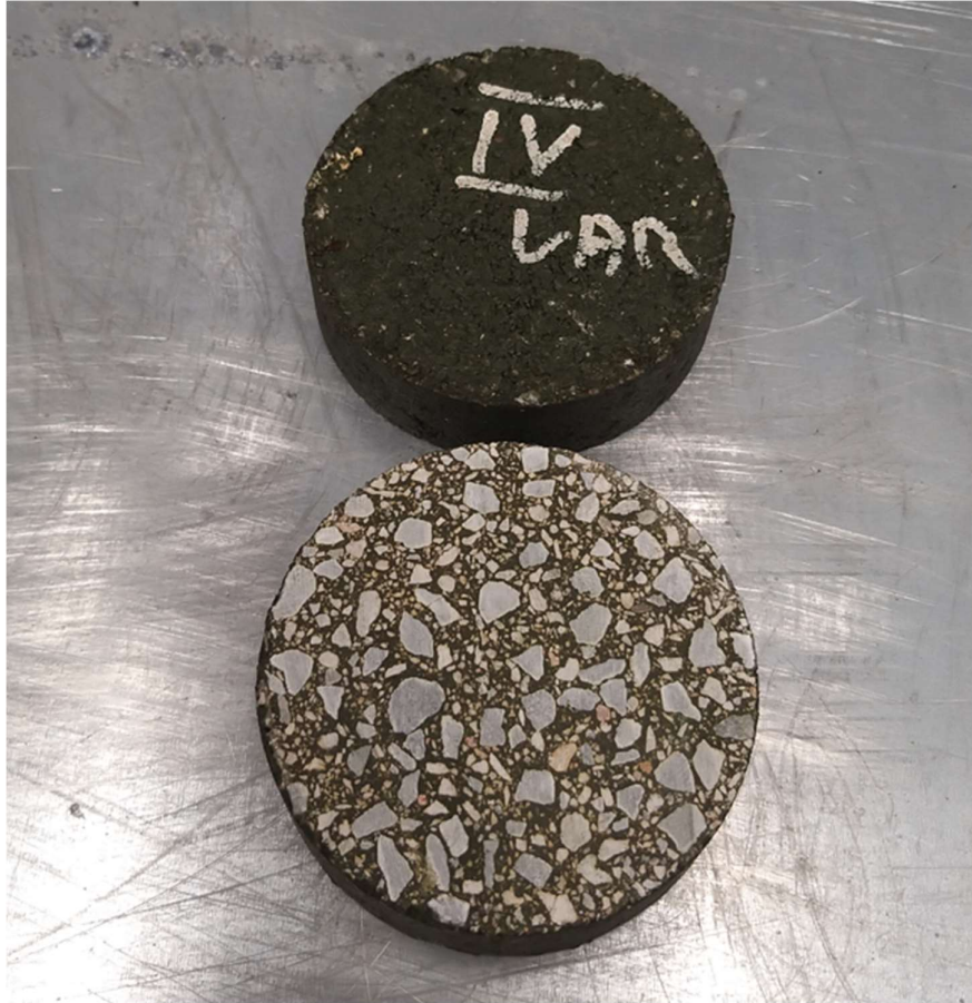
Joonis 3.15. Roheline pooleks saetud asfaldist proovikeha, toodetud KMG OÜ poolt [Erakogu]
