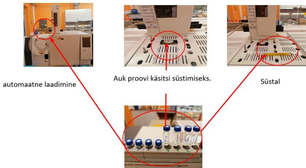
Joonis 5.18 Vialide laadimine GC/MS seadmesse
