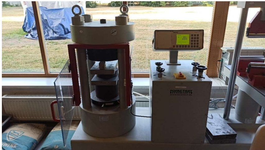
Joonis 6.21. Survekatse seade katsekehaga
