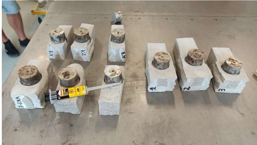
Joonis 6.15. Katsekehad liimitud silindritega
