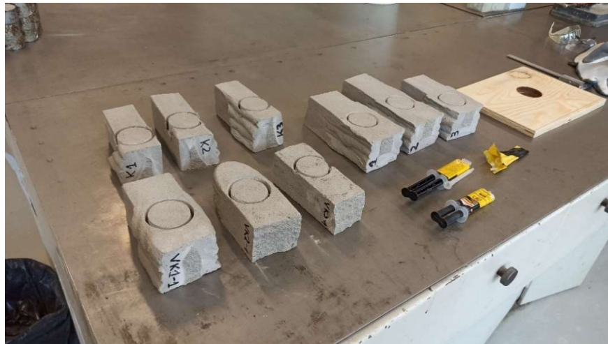
Joonis 6.14. Katsekehad freesitud silindritega
