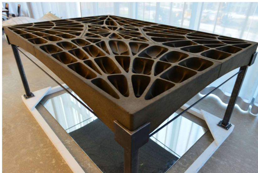
Joonis 3.3. Šveitsi Föderaalsete Tehnoloogiainstituudi Arhitektuuri Osakonna kerge betoonpaneel [17]
