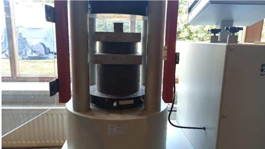
Joonis 6.20. Survekatse seade katsekehaga
