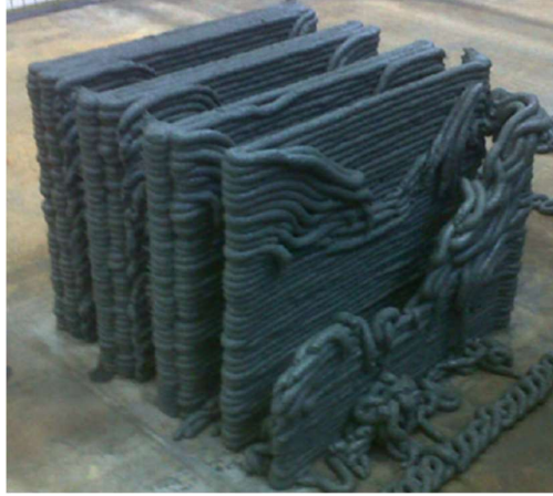
Joonis 4.2. 3D prinditava betooni ülesehitatavus nidususel 0,55 kPa [20]
