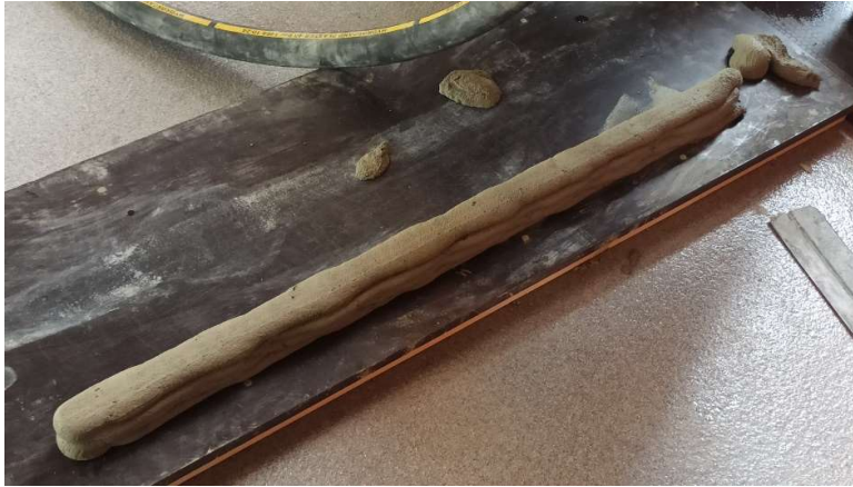
Joonis 6.6. Kiududega betooniga valmis katsekeha
