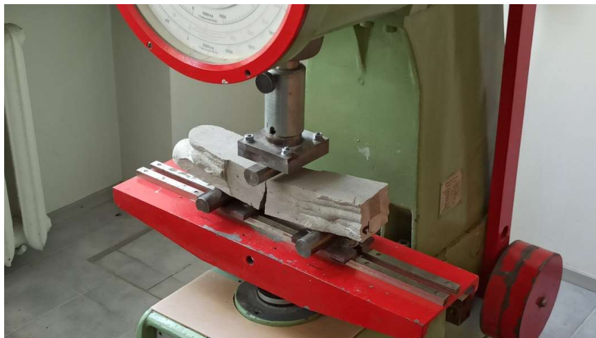
Joonis 6.13. Paindekatse tulemusena purunenud katsekeha 1
