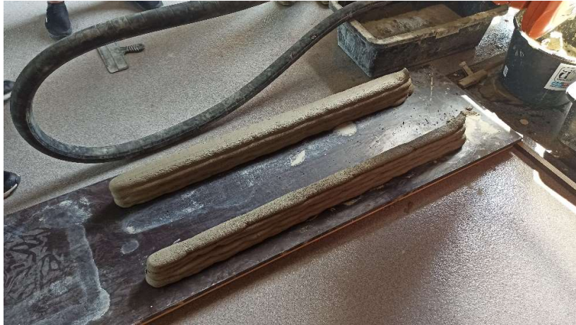
Joonis 6.7. Kaks valmis prinditud 3D betoonist katsekeha kõrvuti
