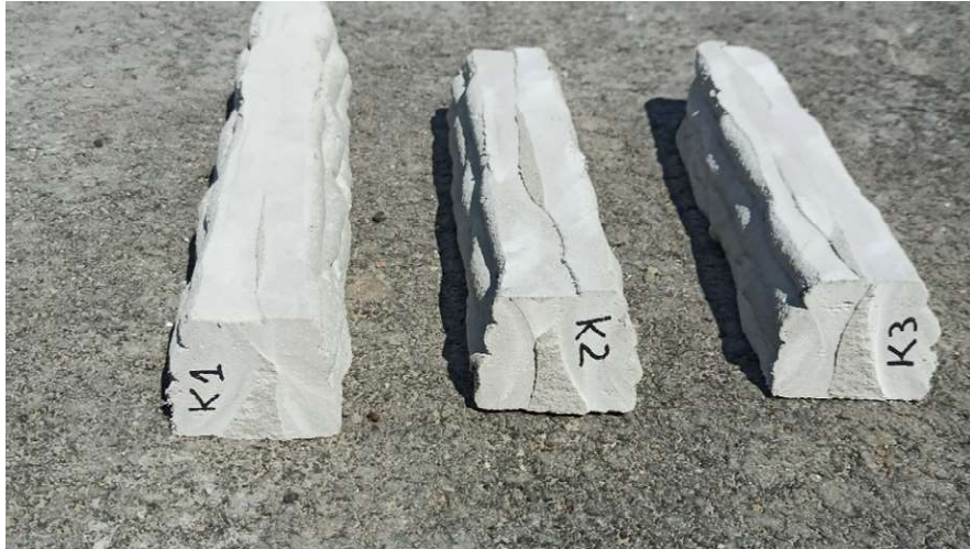
Joonis 6.10. Lihvimata 28-päevased katsekehad kiududega (K1, K2, K3)
