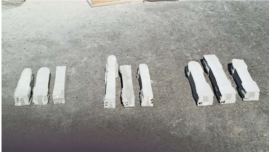
Joonis 6.12. Lihvitud katsekehad ristkülikulise ristlõikega
