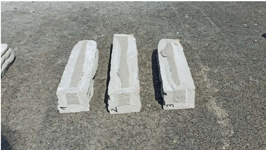
Joonis 6.11. Lihvimata 28-päevased katsekehad ilma kiududeta (1, 2, 3)
