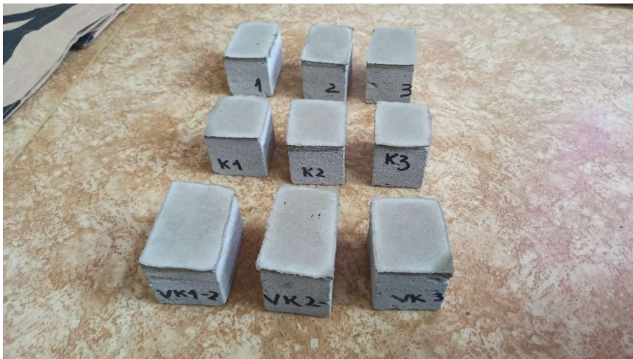
Joonis 6.19. Katsekehad kuivanud tasandusseguga
