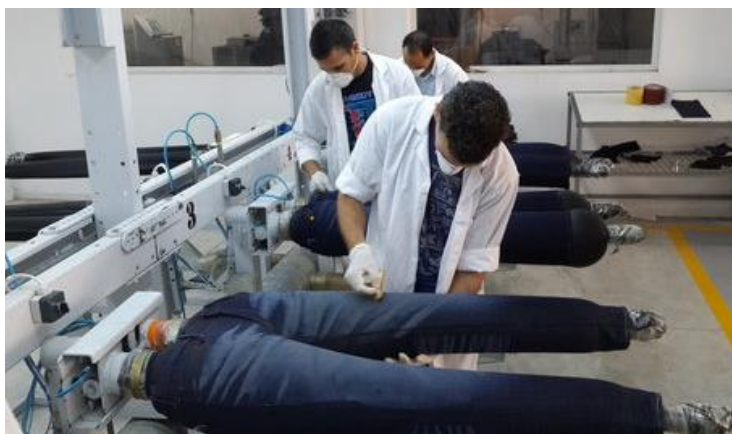
Joonis 9. Käsitsi teksapükstele kulutuse tekitamine [18].
