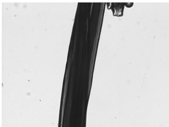
Joonis 13. DD kanga koelõnga sees olev elastaankiud, suurendus 500 korda
