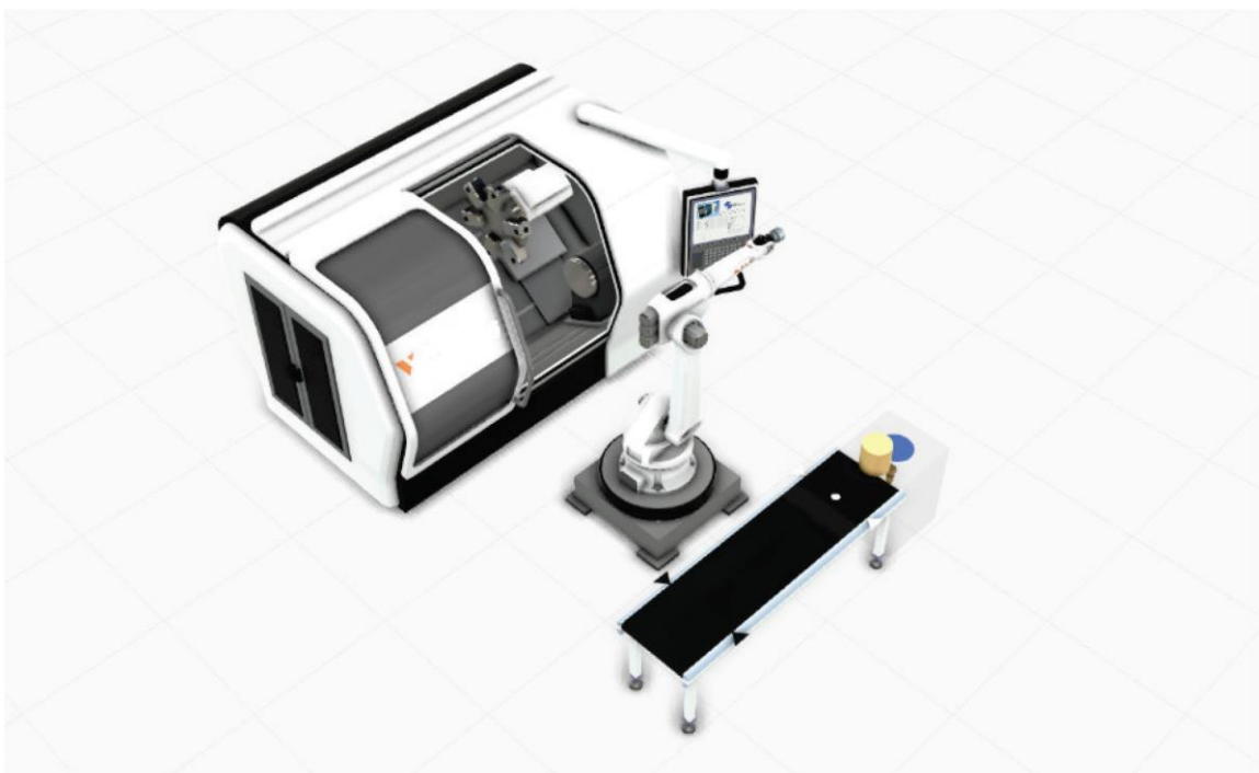
Joonis 15. Protsessi visualiseerimise näide konveieri, tööstusroboti ning CNC seadmega [4]
