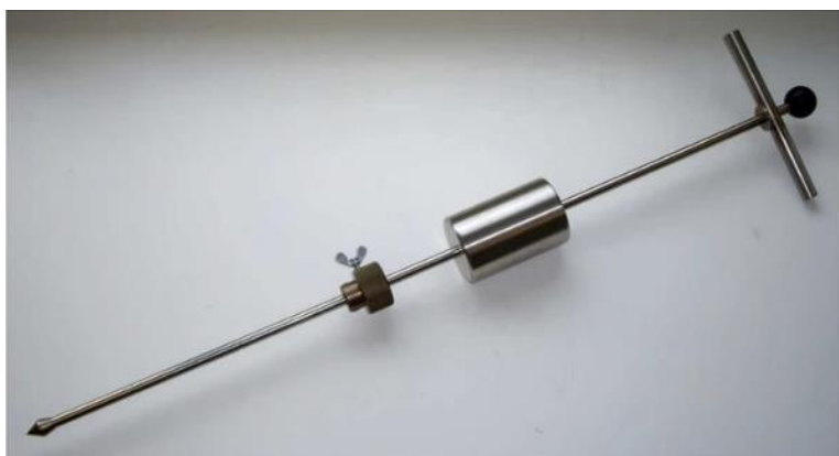
Joonis 1.5 Dünaamiline penetromeeter PM-1 [4].
