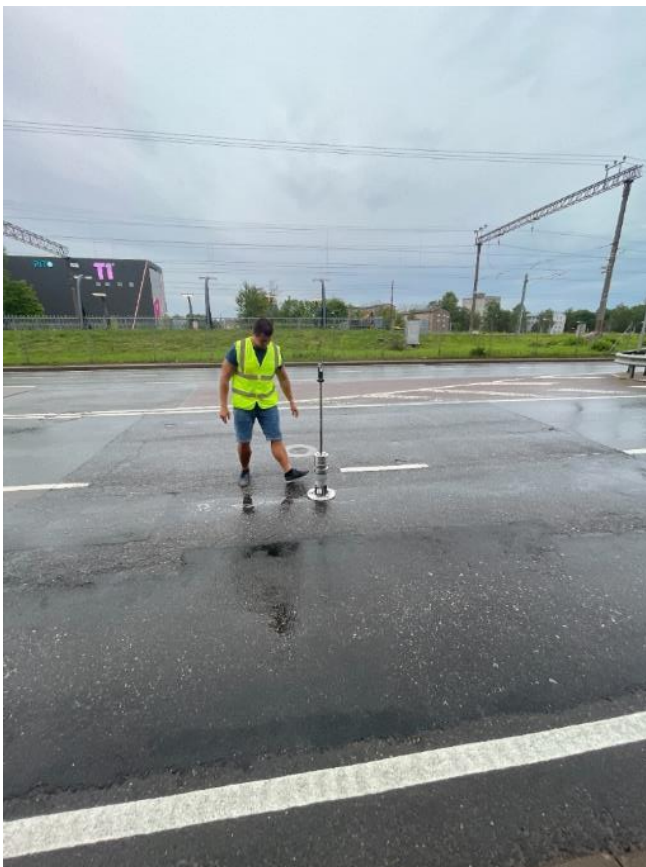
Joonis 18: Asfalteeritud lapi deformeeritavuse mõõtmised Dynatest 3032 LWD deflektomeetriga katseobjektil Suur-Sõjamäe tänav 6.
