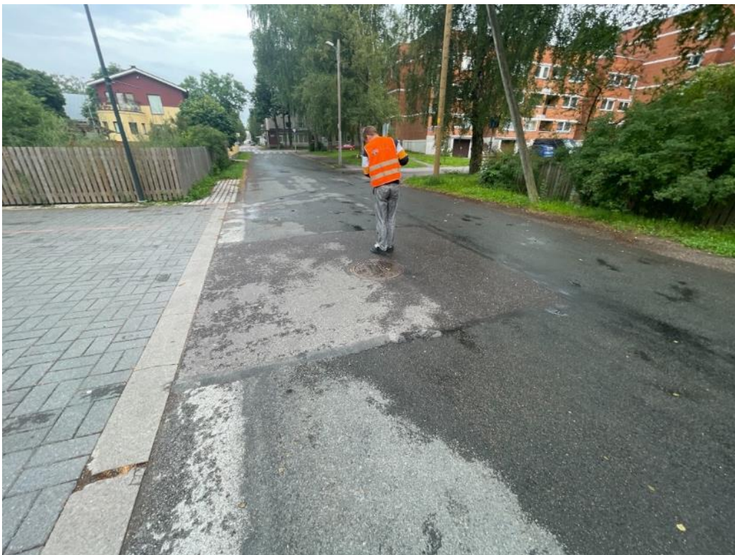
Joonis 54: Asfalteeritud lapi deformeeritavuse mõõtmised Dynatest 3032 LWD deflektomeetriga katseobjektil Rästa tänav 2a.
