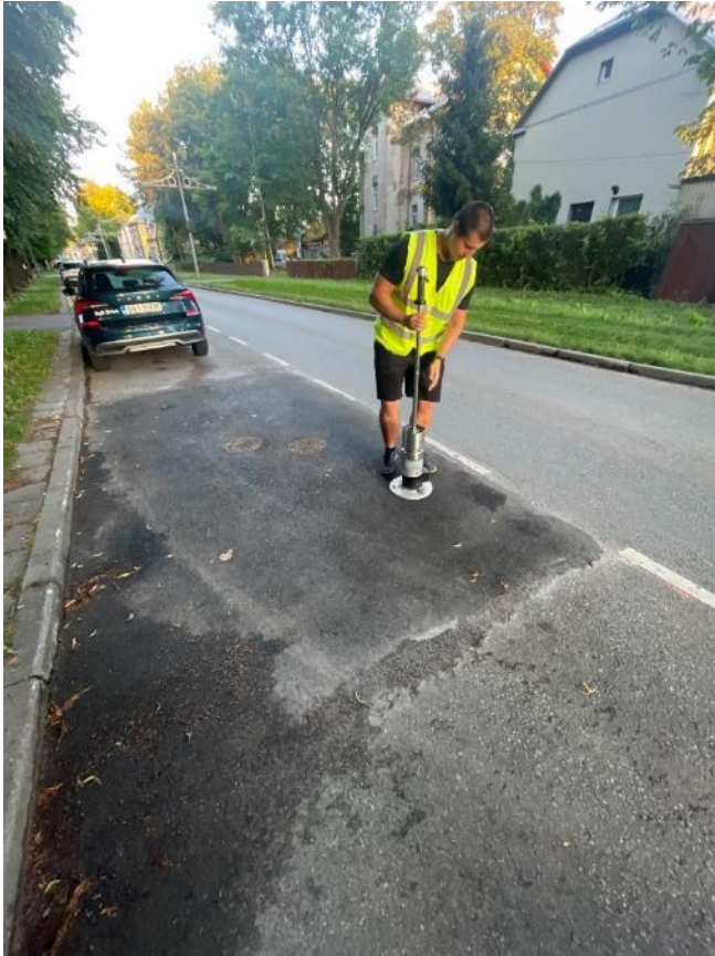
Joonis 3: Asfalteeritud lapi deformeeritavuse mõõtmised Dynatest 3032 LWD deflektomeetriga katseobjektil Kopli tänav 48.
