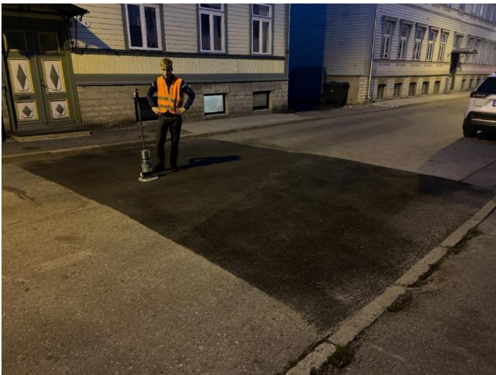
Joonis 38: Asfalteeritud lapi deformeeritavuse mõõtmised Dynatest 3032 LWD deflektomeetriga katseobjektil Sügise tänav 8.
