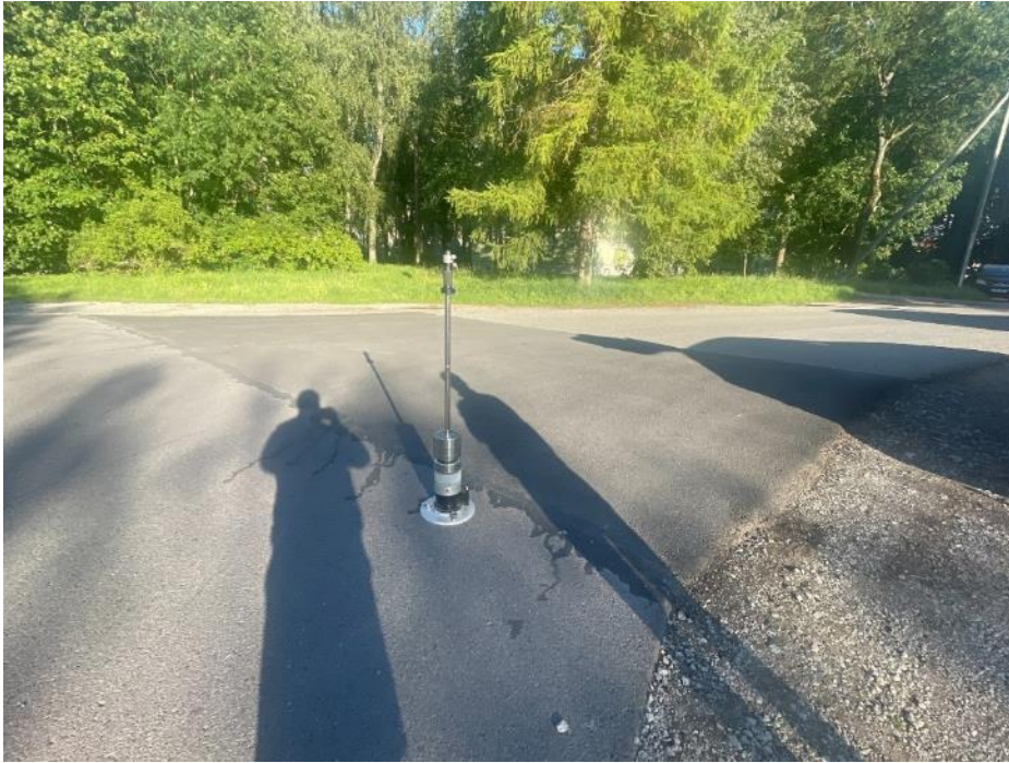
Joonis 13: Asfalteeritud lapi deformeeritavuse mõõtmised Dynatest 3032 LWD deflektomeetriga katseobjektil Lasnamäe tänav 32.
