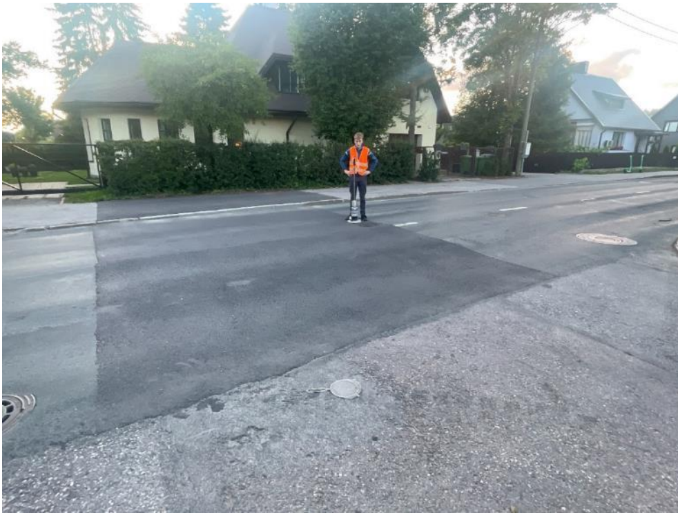
Joonis 41: Asfalteeritud lapi deformeeritavuse mõõtmised Dynatest 3032 LWD deflektomeetriga katseobjektil Randvere tee 51.
