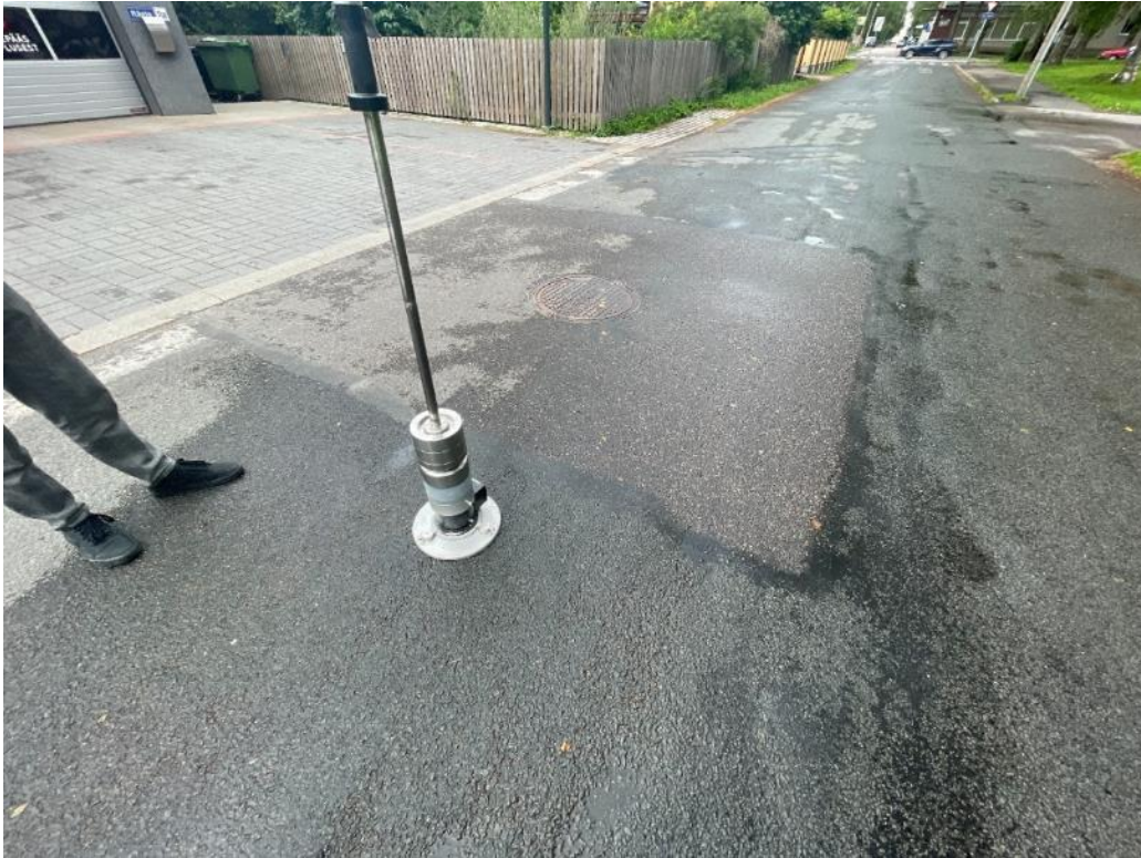
Joonis 53: Asfalteeritud lapi deformeeritavuse mõõtmised Dynatest 3032 LWD deflektomeetriga katseobjektil Rästa tänav 2a.
