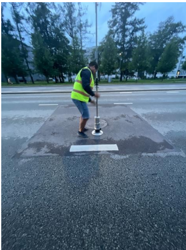
Joonis 20: Asfalteeritud lapi deformeeritavuse mõõtmised Dynatest 3032 LWD deflektomeetriga katseobjektil Ehitajate tee, Õismäe tee 179.
