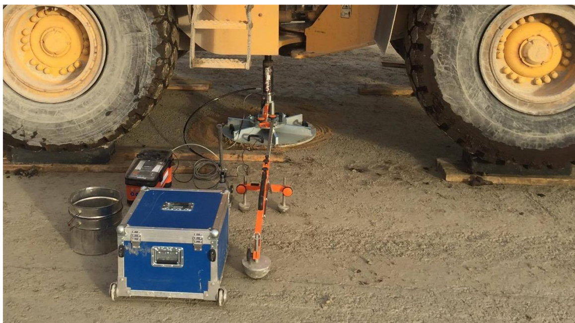
Joonis 1.11 Plaatkoormuskatse seade 762mm plaadiga ning vastukaal (rataslaadur) [11].
