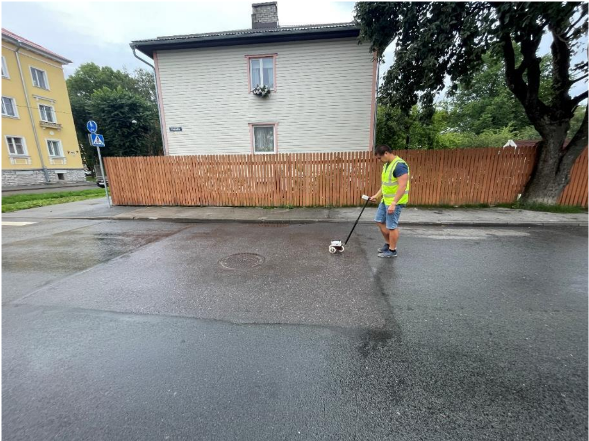
Joonis 1: Puuvilla tänava 32 katseobjektil tasasuse mõõtmine Gapman käsiprofilomeetriga.
