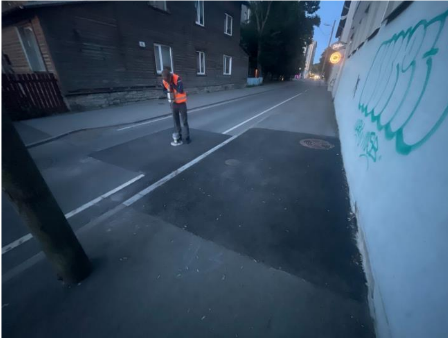
Joonis 43: Asfalteeritud lapi deformeeritavuse mõõtmised Dynatest 3032 LWD deflektomeetriga katseobjektil Vabriku tänav 4.
