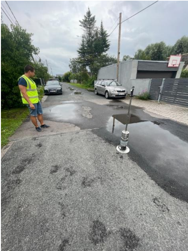
Joonis 24: Asfalteeritud lapi deformeeritavuse mõõtmised Dynatest 3032 LWD deflektomeetriga katseobjektil Looga tänav 15.
