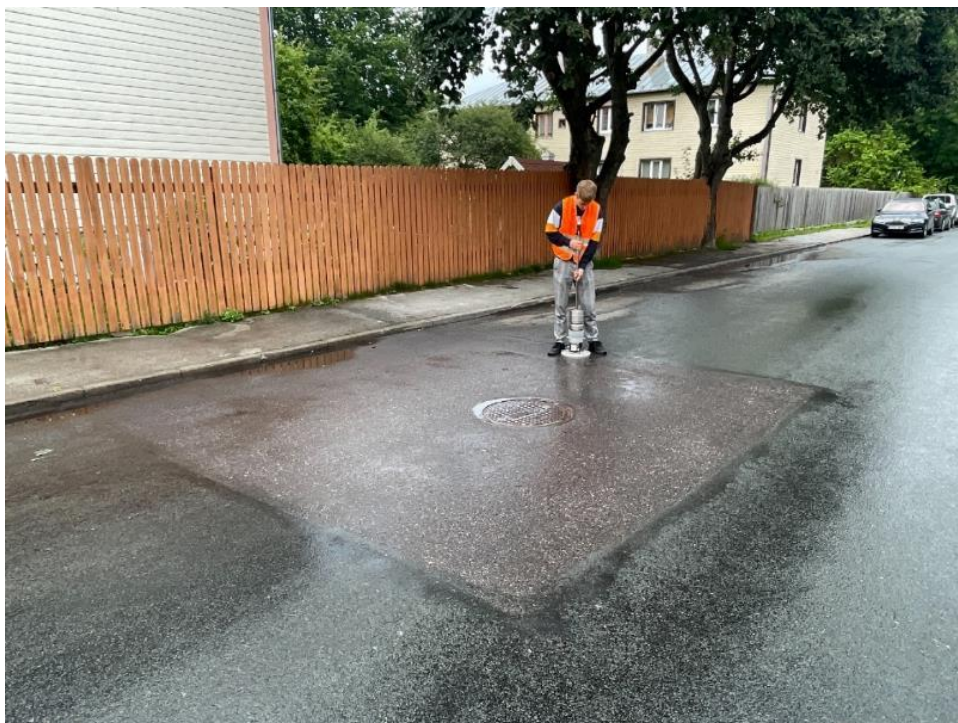
Joonis 56: Asfalteeritud lapi deformeeritavuse mõõtmised Dynatest 3032 LWD deflektomeetriga katseobjektil Puuvilla tänav 32.
