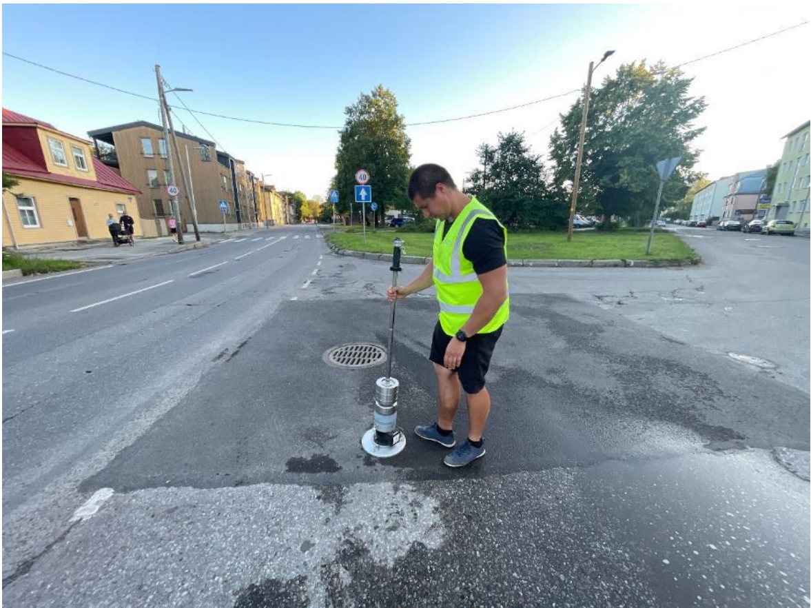
Joonis 6: Asfalteeritud lapi deformeeritavuse mõõtmised Dynatest 3032 LWD deflektomeetriga katseobjektil Mulla tänav 2.
