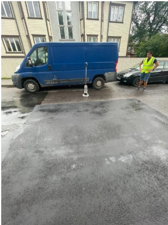
Joonis 27: Asfalteeritud lapi deformeeritavuse mõõtmised Dynatest 3032 LWD deflektomeetriga katseobjektil Härjapea tänav 23.
