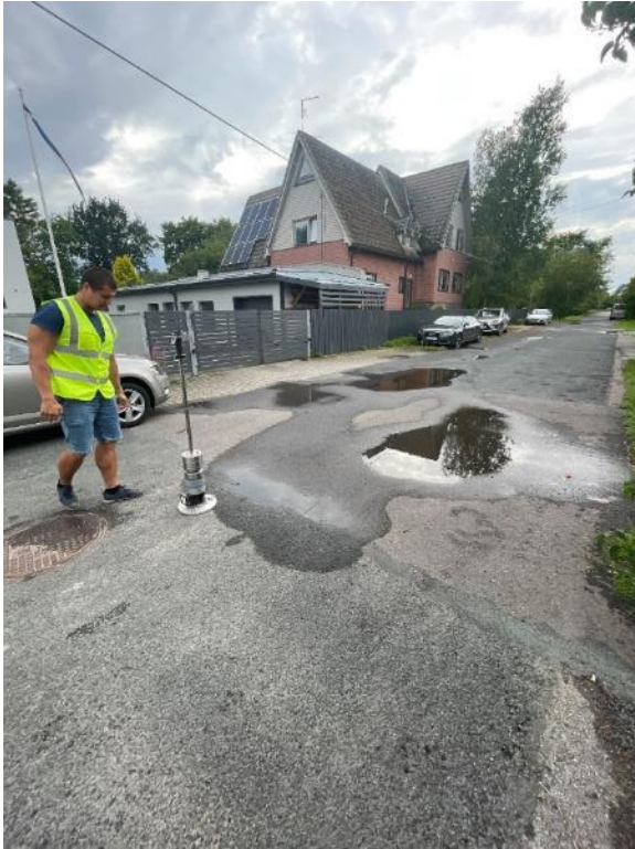
Joonis 23: Asfalteeritud lapi deformeeritavuse mõõtmised Dynatest 3032 LWD deflektomeetriga katseobjektil Looga tänav 15.
