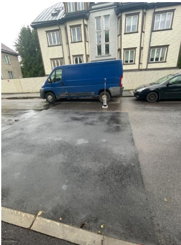
Joonis 26: Asfalteeritud lapi deformeeritavuse mõõtmised Dynatest 3032 LWD deflektomeetriga katseobjektil Härjapea tänav 23.
