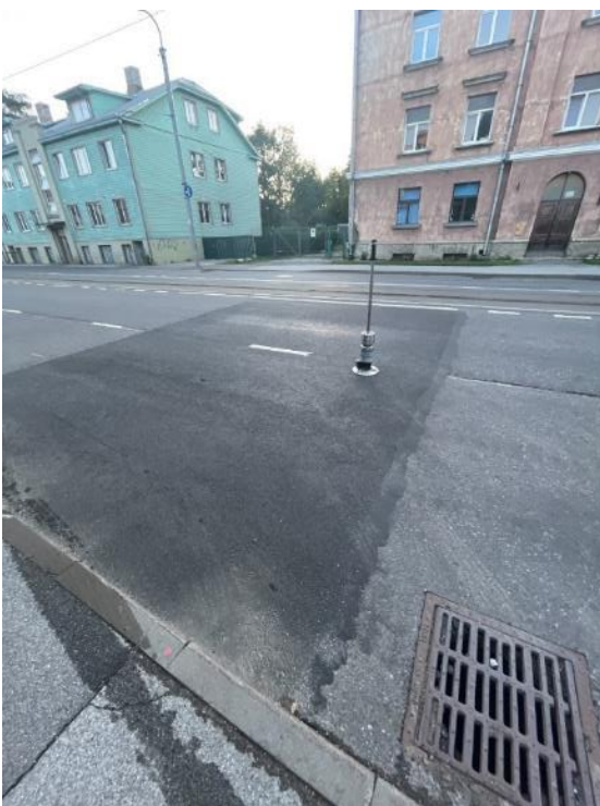
Joonis 16: Asfalteeritud lapi deformeeritavuse mõõtmised Dynatest 3032 LWD deflektomeetriga katseobjektil Tondi tänav 3.
