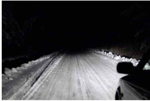
Joonis 5.1 Ebasümmeetriline lähituli [2].
