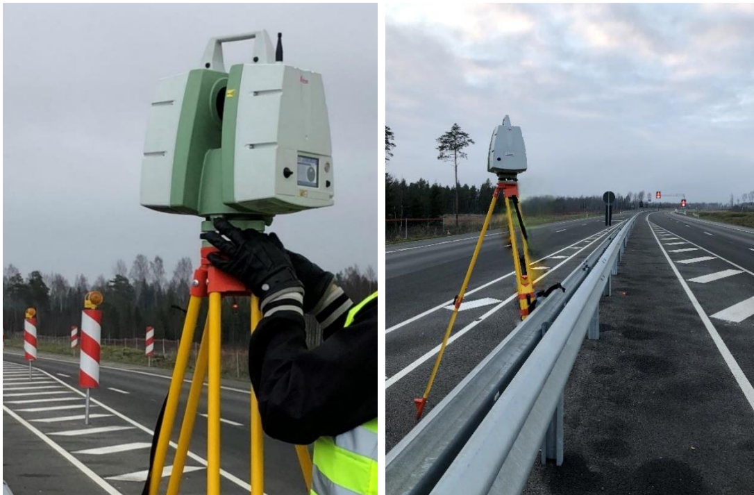
Joonis 12. Kasutatud laserskanner Leica ScanStation C10.
