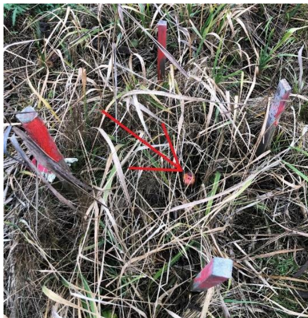
Joonis 10. Aluskivimini ulatuv reeper (Rp1 Joonisel 11) objekti vahetus läheduses.
