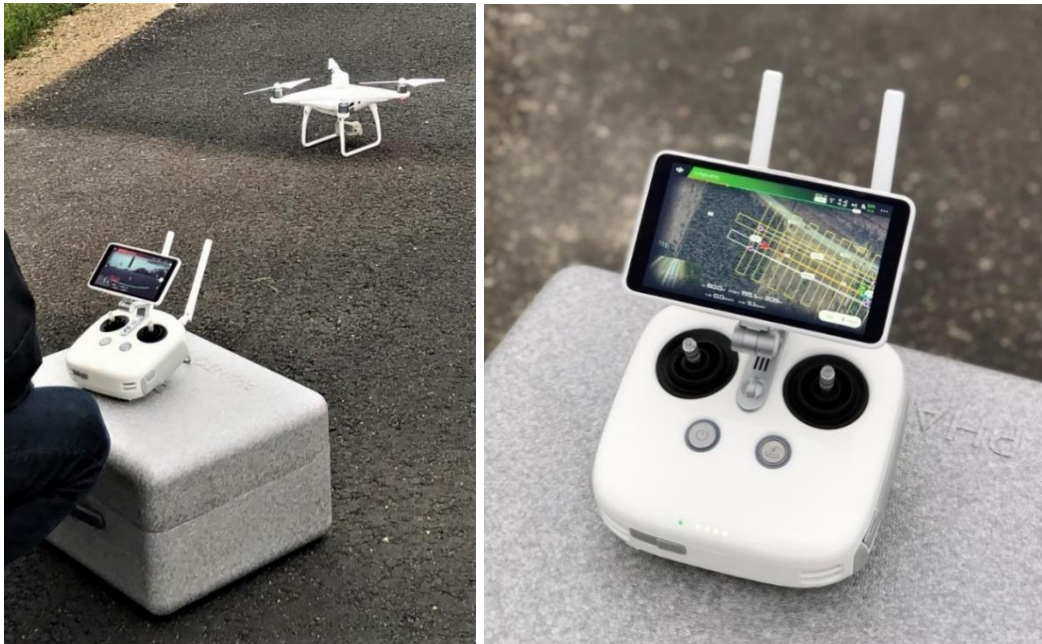
Joonis 16. Kasutatud droon DJI Phantom 4 RTK (vasakul) ja drooni maapealne juhtimissüsteem (paremal).
