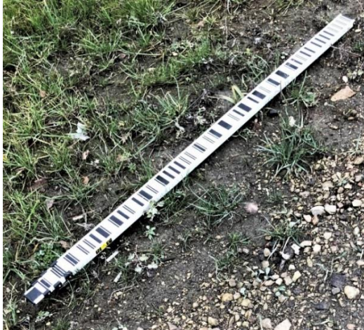
Joonis 9. Mõõdistustöödel kasutatud ribakoodlatti.
