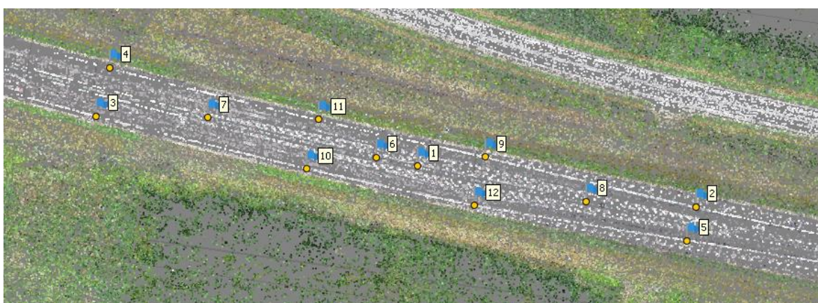
Joonis 19. Uuritava teelõigu mudel esitatuna hõreda punktipilvena (pealtvaade). Töö projekti on lisatud 12 kontrollpunkti.
