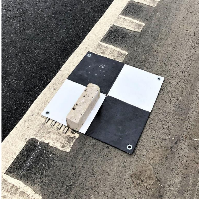
Joonis 18. Tähis paigaldatuna maapealsele kontrollpunktile.
