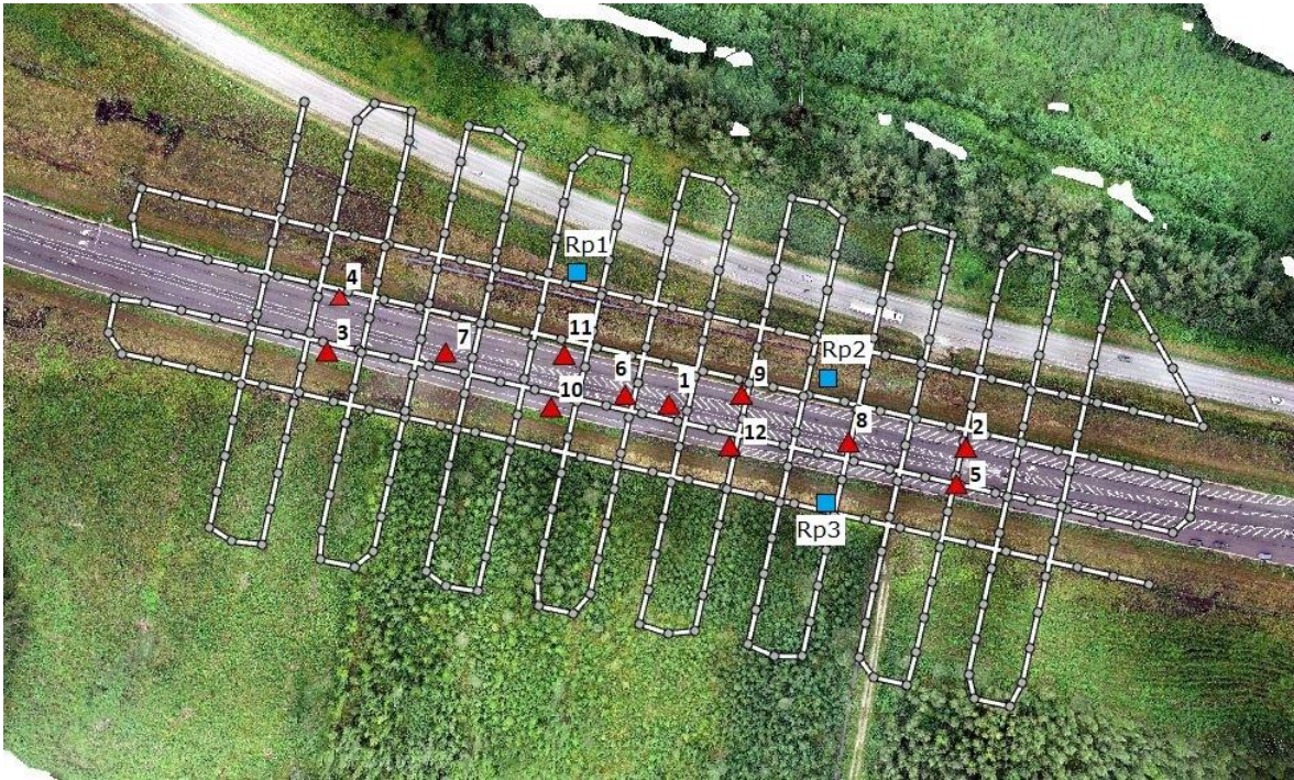
Joonis 11. Ortofotomosaik drooni lennu trajektooriga (valge joon, millel olevad punktid näitavad fotode tegemise asukohtasid). Punased kolmnurgad tähistavad maapealsete kontrollpunktide asukohtasid (uuritav teelõik algab punktide 4 ja 3 juures ning lõppeb punktidega 2 ja 5) ning sinised ruudud lähtereepereid.
