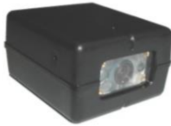
Joonis 2.9. Koodilugeja CAT-FM204SF-P4G [17]
