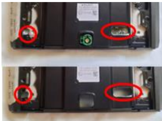
Joonis 2.7. Aukude asukoht täiendav kinnituse
