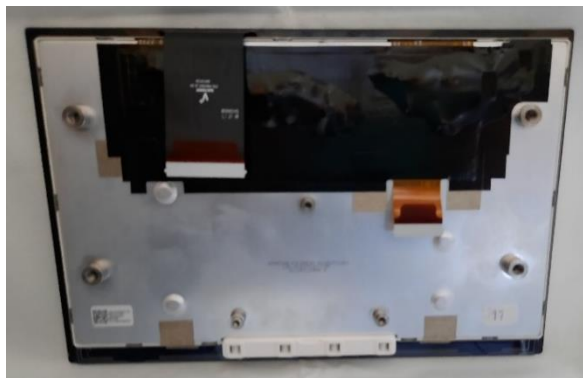
Joonis 1.4. Puutetundliku ekraani tagantvaade.
