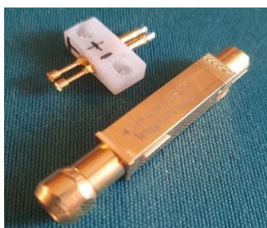
Joonis 2.19 Konnektor INGUM HFS-819 [25]
