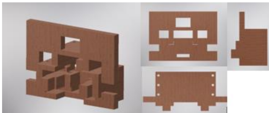
Joonis 2.3. Kinnituse põhivaade / eestvaade / pealtvaade / külgvaade
