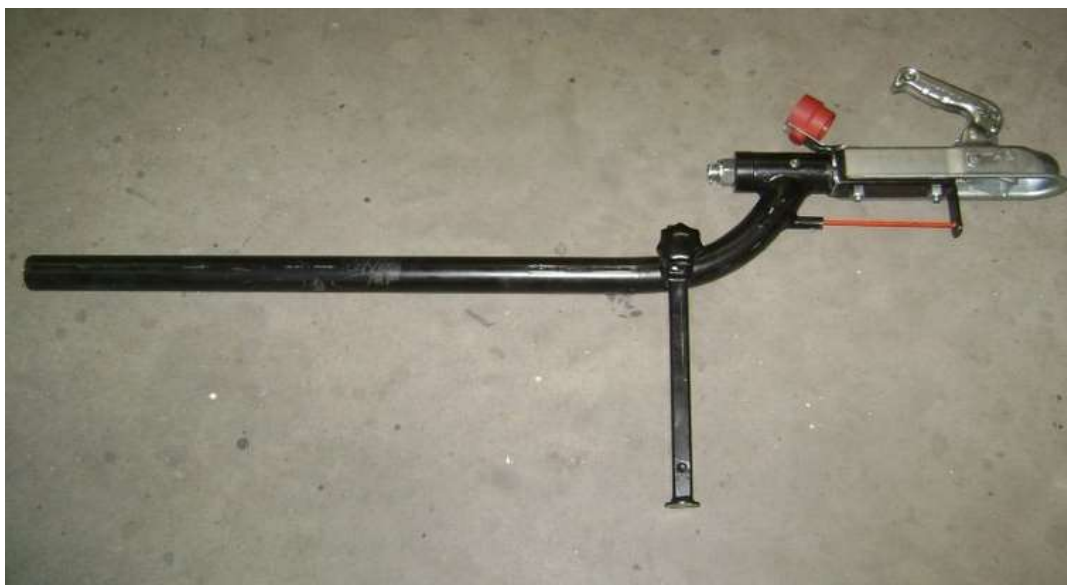
Joonis 4.15 Kasutatav keerleva veopeaga tiisel koos tugijalaga
