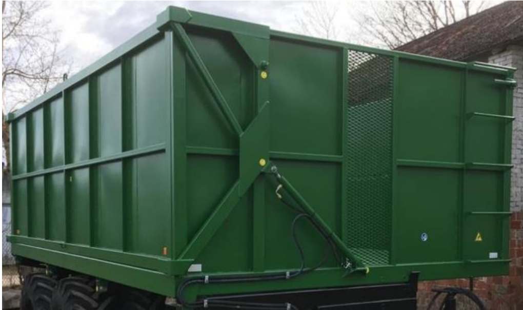
Sele 4.10 Värvitud kast hüdrotsilindriga
