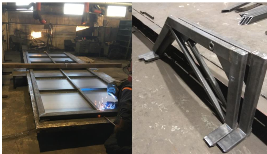
Sele 4.7 Küljeluuk ja tõstmisraamistik
