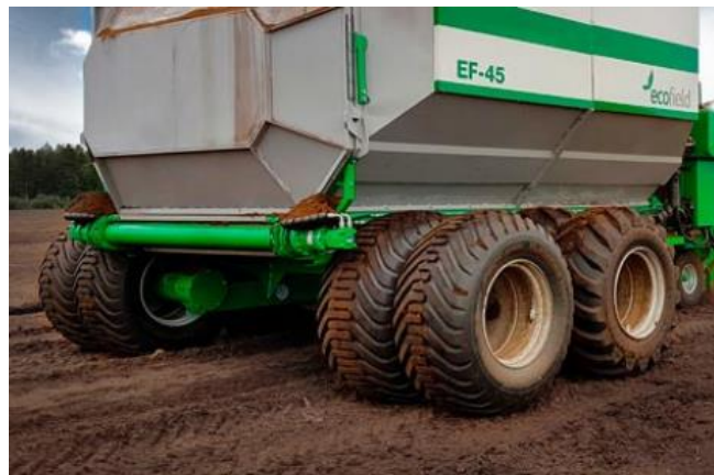
Sele 4.30 Balansiiride kasutamine paarisratastega [21]
