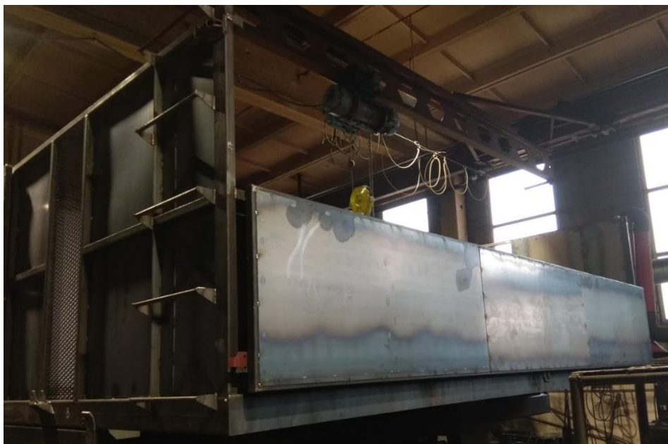
Sele 4.5 Laadimiskõrguse muutmist võimaldav luuk avatult
