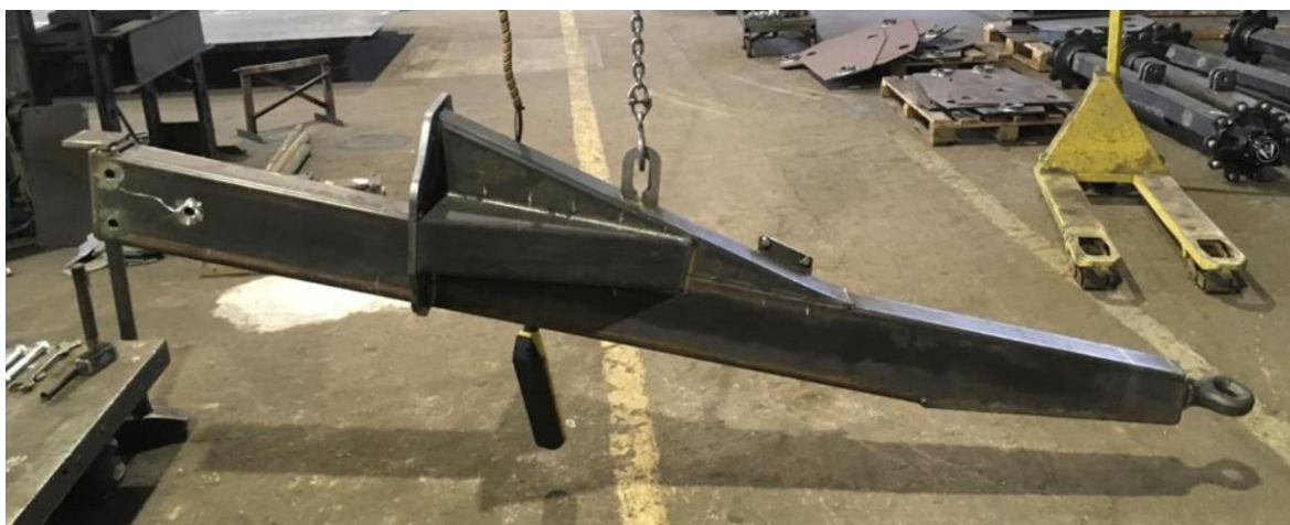
Sele 4.42 Tõsteaasa kaudu tõstetud tiisel
