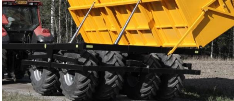
Sele 4.29 Ridamisi paigutatud rattad [11]
