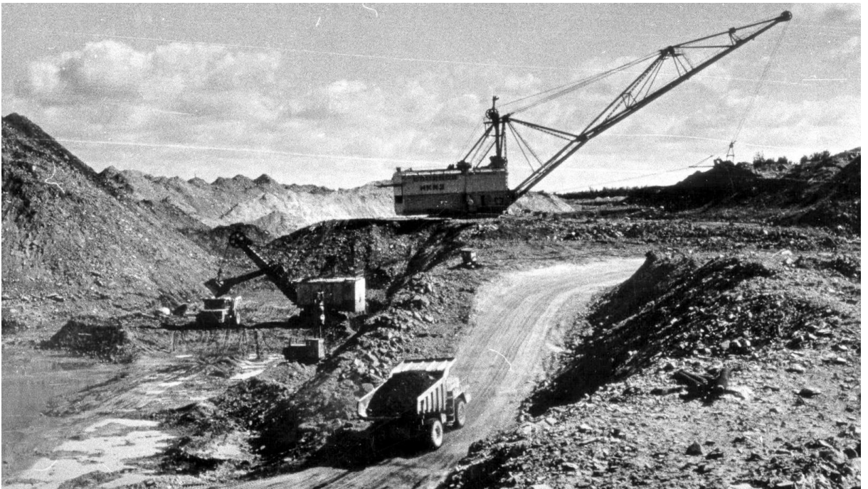
Pilt 3.8 Fosforiidi vaalkaevandamine Taamal paljandav draglain, kaevikus laeb kaevist pärikopp ja veavad karjäärikallurid.
