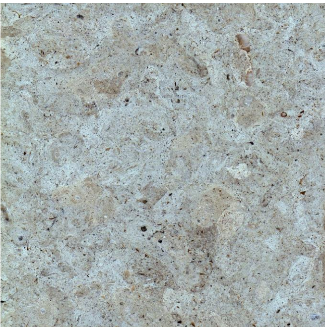
Pilt 2.23 Ehituspaas: rohmakast paekivist laotud sepikoda Rock-al-Mare vabaõhumuuseumis (N 59°25'59"; E 24°38'37"); ja Lasnamäe lademe ehituspae poleeritud näidis, 10 x10 cm
