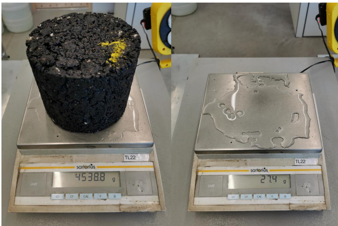
Joonis 4.3 Immutatud ja kuivatatud pinnaga proovikehast vee väljanõrgumine EVS-EN 12697-6 B meetodi kaalumise protsessis
