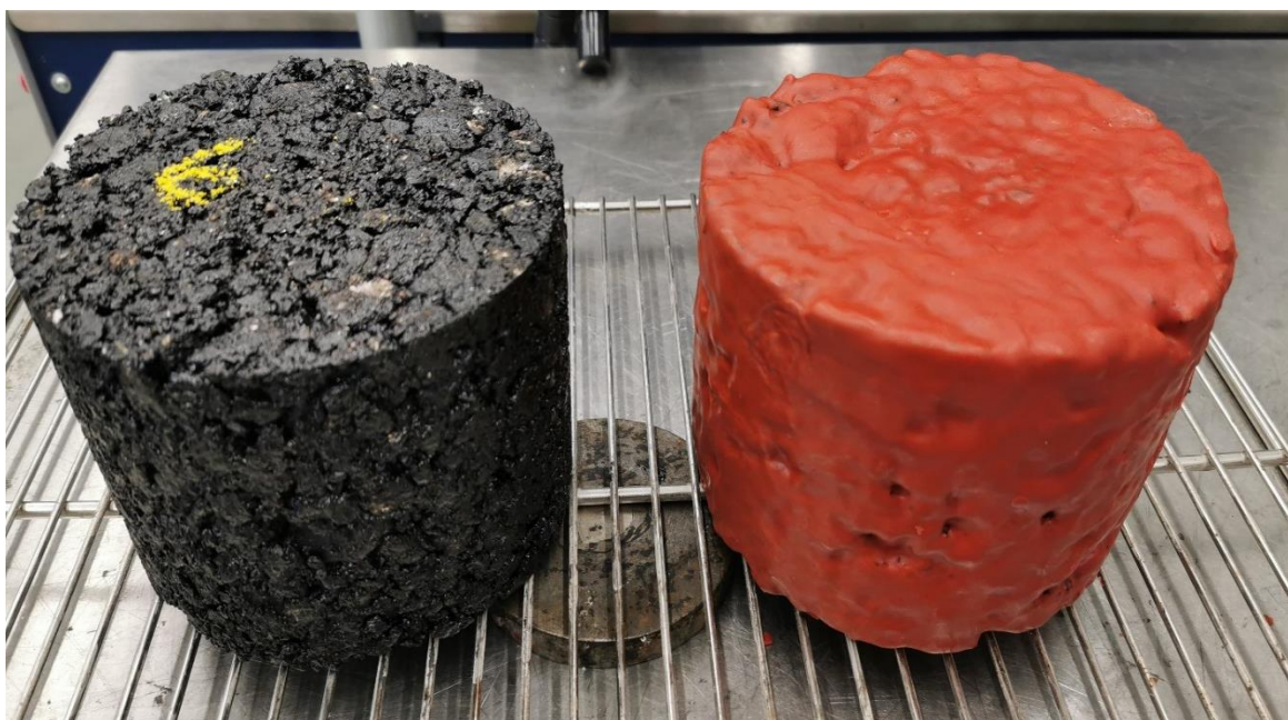
Joonis 4.4 Parafiinvahaga katmata ja kaetud AC 32 base proovikeha
