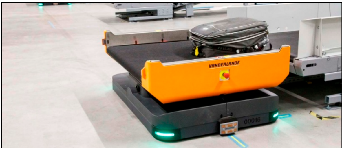
Joonis 1.2 Vanderlande' autonoomne veok [19]
