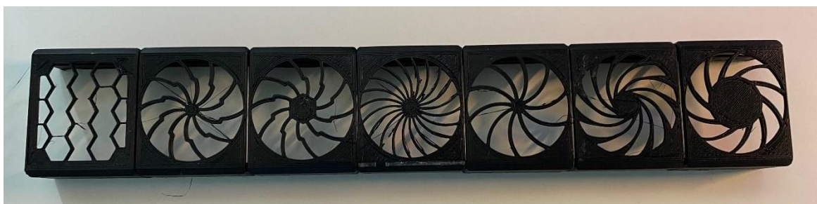
Pilt 2.19 – Erinevate ventilaatorite mustrite testimine
