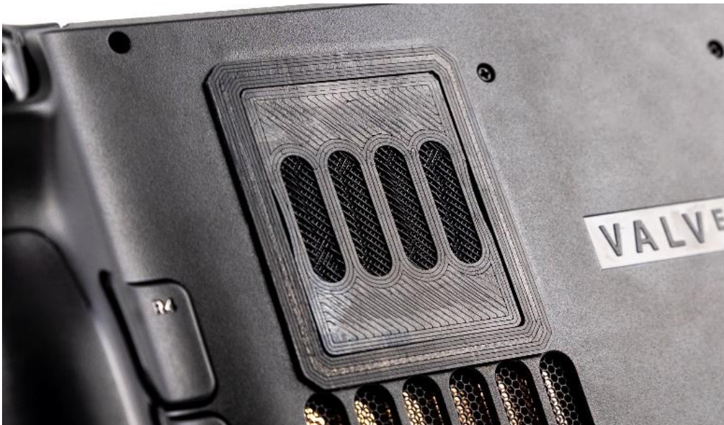
Pilt 2.26 – Ääretüki viimane versioon paigaldatud konsooli külge
