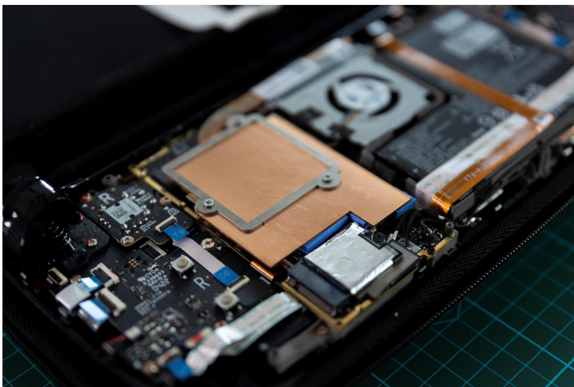
Pilt 3.3 – CoolerDeck paigaldatud kujul konsooli sees
