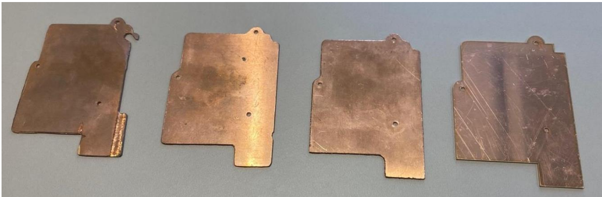
Pilt 2.4 – Vaheplaadi vask prototüübid, viimane versioon laserlõikusega
