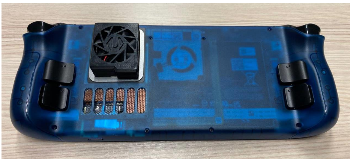
Pilt 3.4 – Kolmanda osapoole kattega CoolerDeck -i installatsioon
