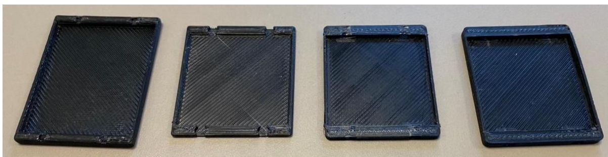
Pilt 2.28 – CoolerDeck -i katete prototüübid
