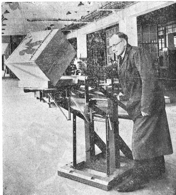
Langeproov. Hoova tõmbamisega langeb kast koos apa- raadiga põrandale. Kast ja aparaat peavad tugevalt vigas- tusetat välja kannatama. (Philips tehased.)
