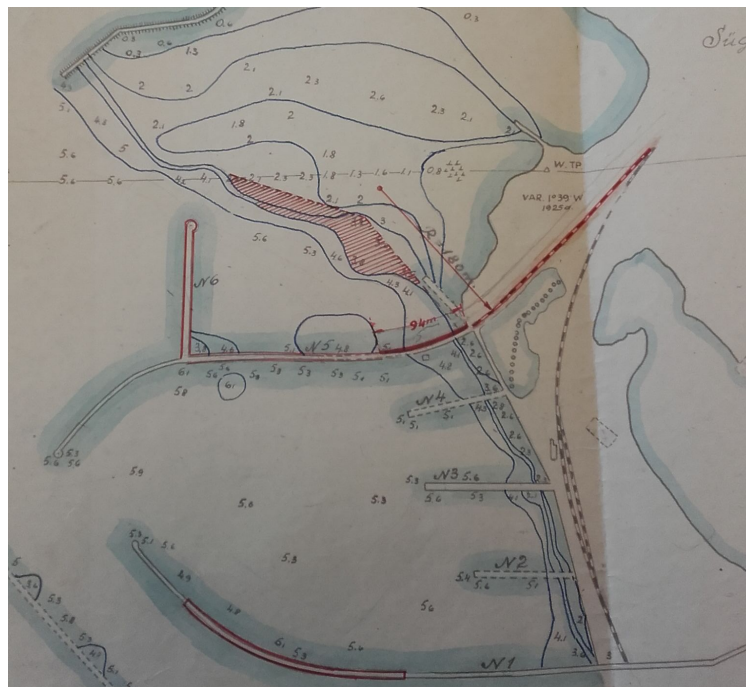
Joonis 4.3.2 Rohuküla sadama ümberehituse plaan 28.07.1928
