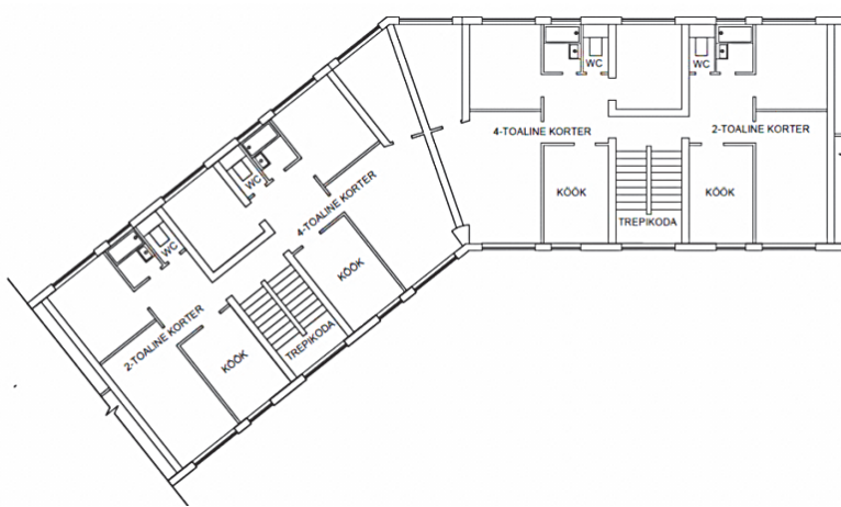
Joonis 11. Suurpaneel lamu I korruse fragment vinklikohast 91
