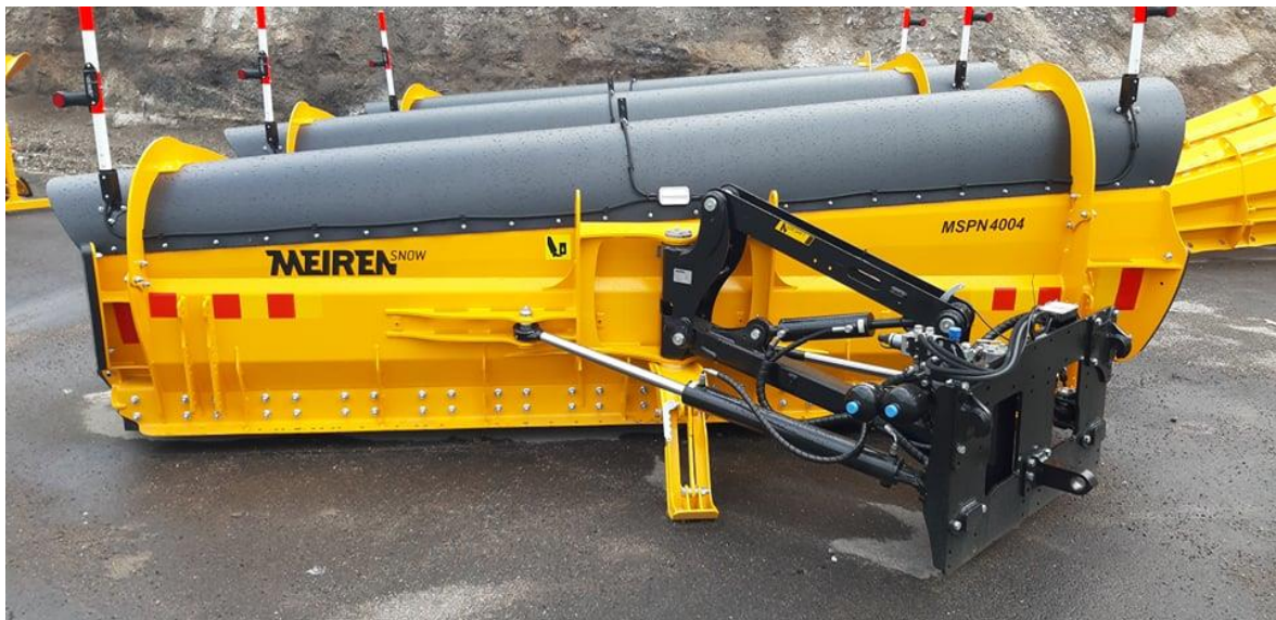
Joonis 1.1. Meiren Engineering OÜ poolt toodetud sahk parallelogrammiga
