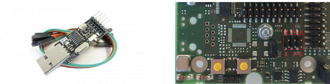
Joonis 8. TTL-USB konverter (vasakul) ja deRFnode arendusplaadi X5 liides nummerdatud viikudega (paremal).
