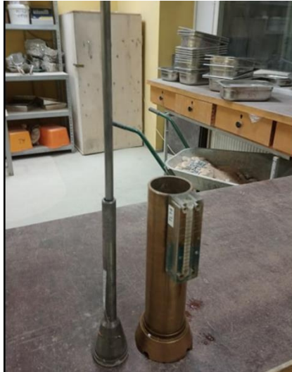
Joonis 1.9 Sojuzdornii katseseade (paremal) koos tihendushaamriga (vasakul) [autori foto]
