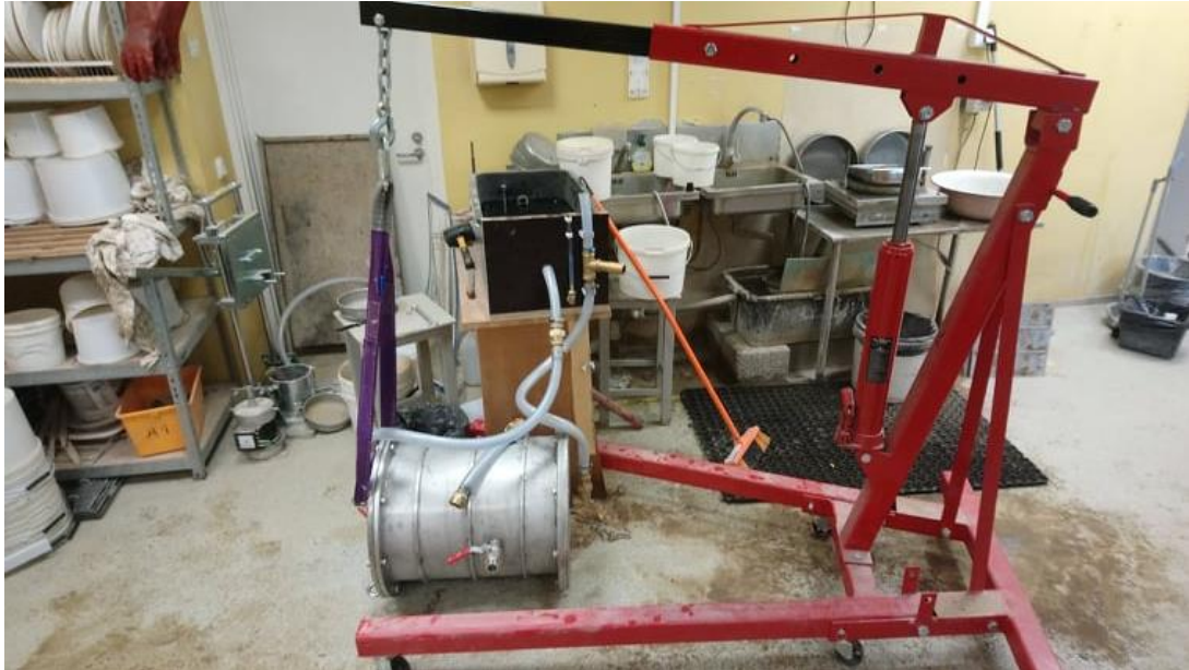
Joonis 3.6 Külili ehk 90° keeratud silindriga permeameetriga kontrollmõõtmise teostamine
