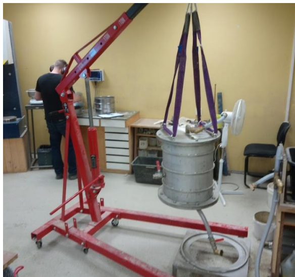
Joonis 2.11 Permeameetri silindri tõstmine alusele [autori foto]
