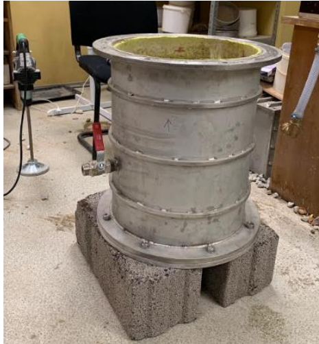
Joonis 2.10. Fibo-plokkidele asetatud permeameetri silinder [autori foto]
