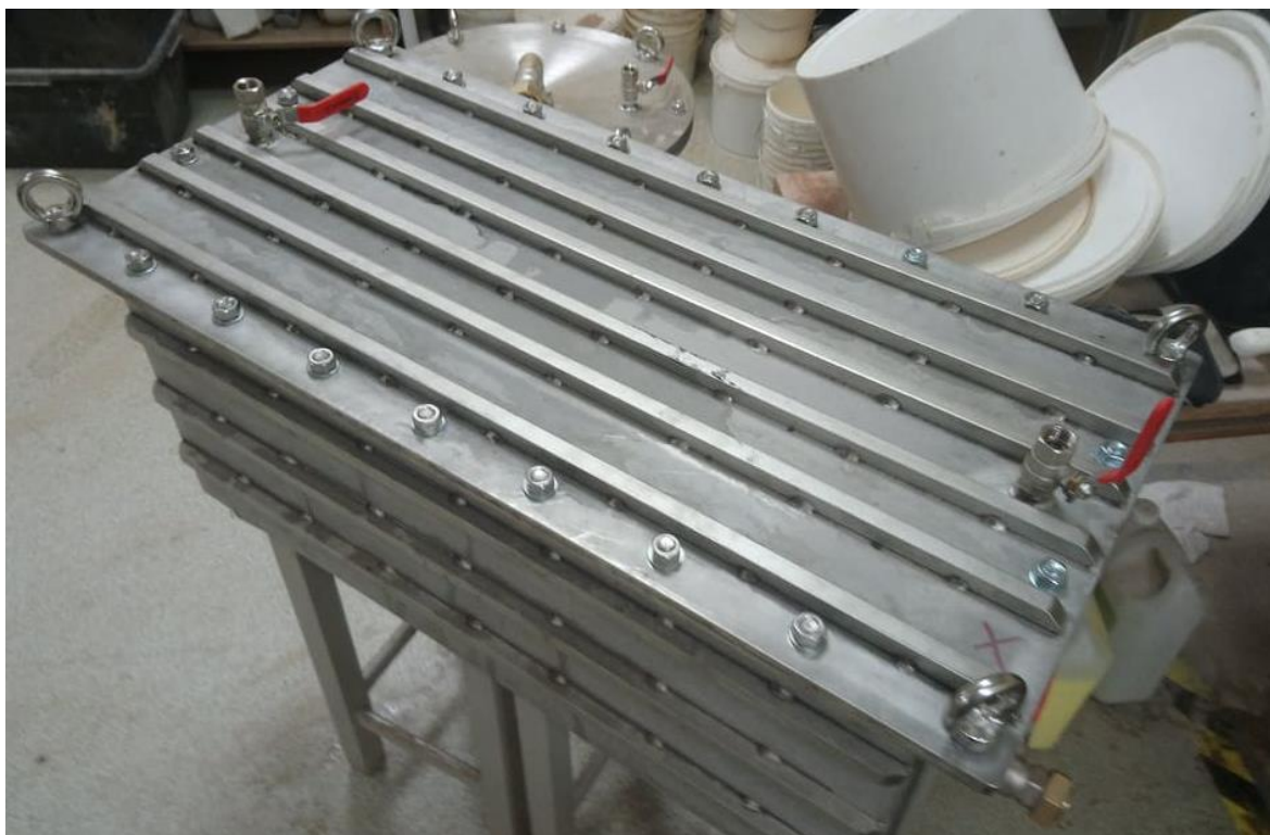
Joonis 2.6 Horisontaalse püsiva rõhuga permeameetri kast [autori foto]
