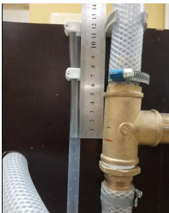
Joonis 2.3 Hüdraulilise gradiendi muutmise [autori foto]
