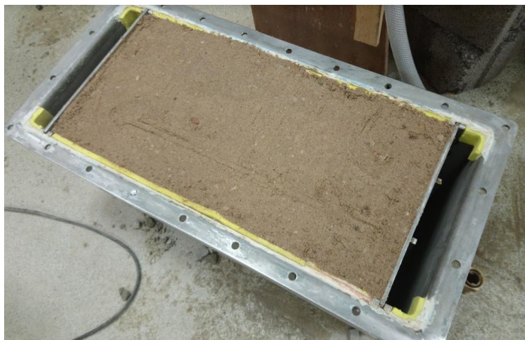
Joonis 2.12 Materjaliga täidetud horisontaalne permeameeter [autori foto]
