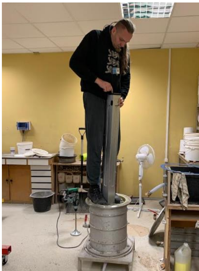
Joonis 2.9 Permeameetrisse tihendatud killustiku tiheduse kontroll Inspectoriga [autori foto]
