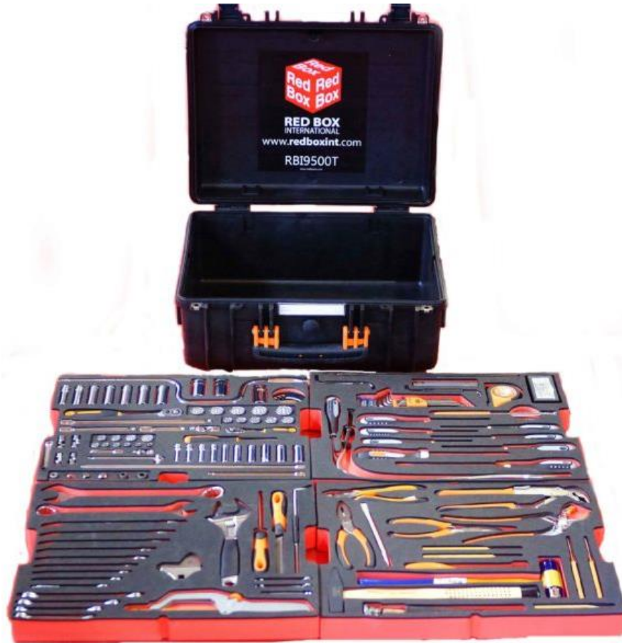
Joonis 2.1 Lahti pakitud tööriistakohver, kus on kasutatud tööriistade varjutamist, koos vahtplaatide kihtidega [9]
