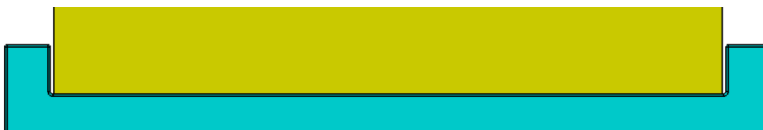
Joonis 6.4 Ekraanitõmmis programmist FreeCAD. Prototüübi altvaade. elektroonika sektsiooni aluse küljes olevad suunajad. Kollane - kaalu osa, sinine - elektroonika sektsiooni korpuse alus
