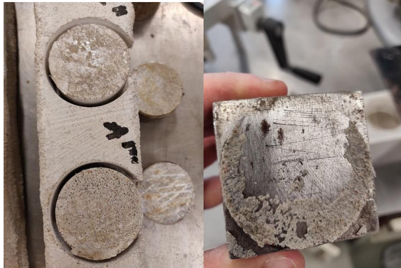
Joonis 3.18 Katsekeha purunemine liimi piirkonnast
