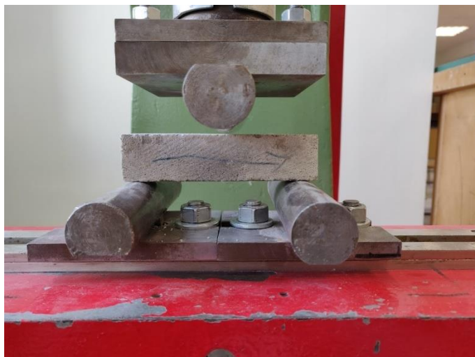
Joonis 2.13 30x30x120 mm katsekeha paiknemine katsemasinas. Noolega on näidatud printimise suund
