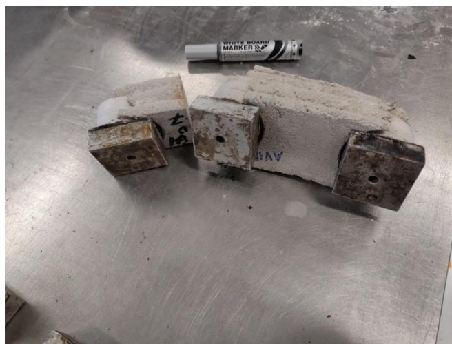
Joonise 3.19 Katsekeha purunemine katsetatava piirkonna kõrvalt
