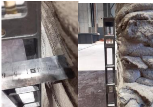
Joonis 2.7 Printimise käigus tekkiv ebatasasus kihtide vahel (foto Jürgen Tammepärg, 2022)
