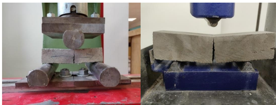
Joonis 2.19 Paindekatse tagajärjel tekkinud purustused
