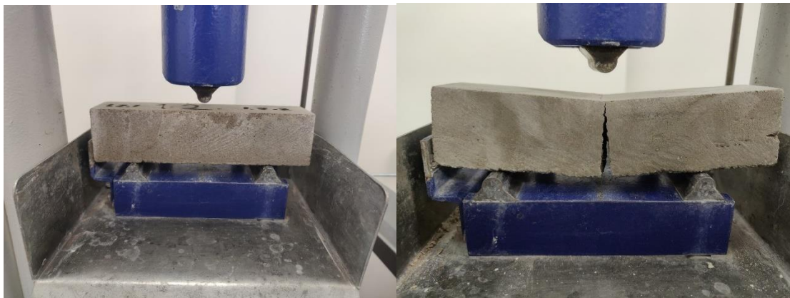
Joonis 3.17 Paindekatsete katsekeha enne ja pärast purustamist
