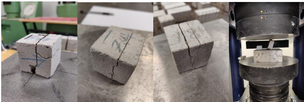
Joonis 3.15 Lõhestuskatse tagajärjel tekkinud purustused
