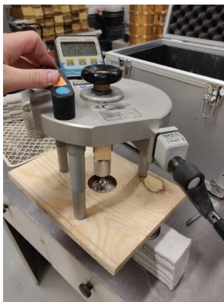
Joonis 2.17 Väljatõmbe katse jaoks kasutatud seade
