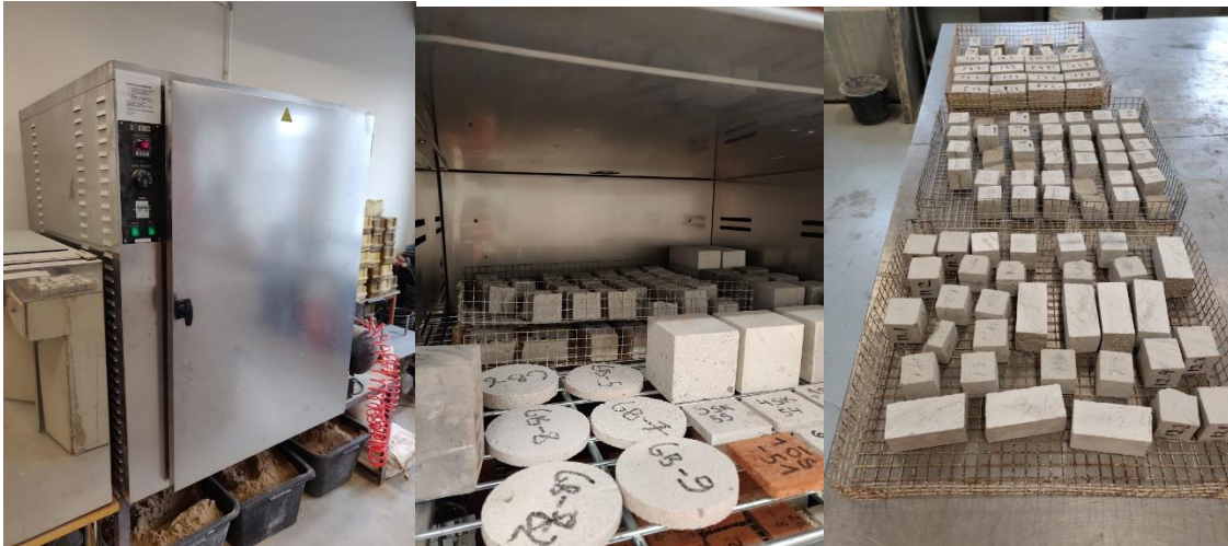
Joonis 2.23 Vasakult paremale: kuivatuskapi välisvaade, katsekehad kuivatuskapis, katsekehade paiknemine alusel, millega need olid kuivatuskapis.
