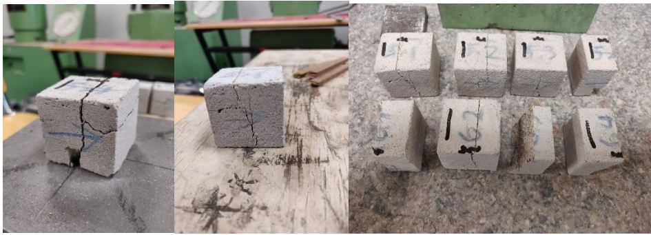
Joonis 2.20 Lõhestuskatse tagajärjel tekkinud purustused
