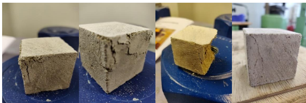
Joonis 2.18 Survekatse tagajärjel tekkinud purustused
