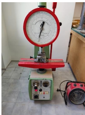
Joonis 2.12 30x30x120 katsekehade purustamiseks kasutatud paindestend. Üleval koormuse suuruse mõõdik. All masina käima panemise lüliti ja opereerimise lülitid
