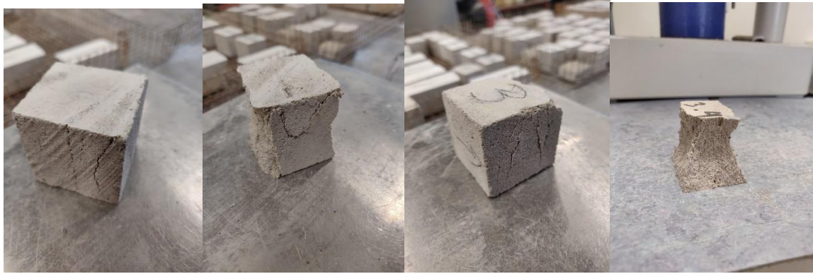
Joonis 3.16 Survekatsel tagajärjel tekkinud purustused
