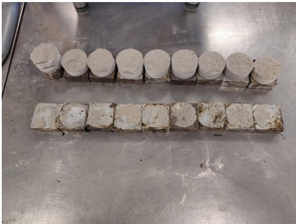
Joonis 3.21 Ülevalt alla: õnnestunud väljatõmbe katsed, ebaõnnestunud väljatõmbe katsed
