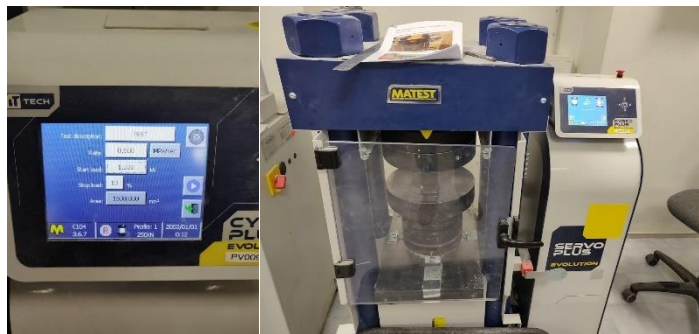
Joonis 2.10 Survestend ja selle parameetrid. Paremal surve ja lõhestuskatsete jaoks kasutatud aparaat. Vasakul masina seadistuseks kasutatud parameetrid
