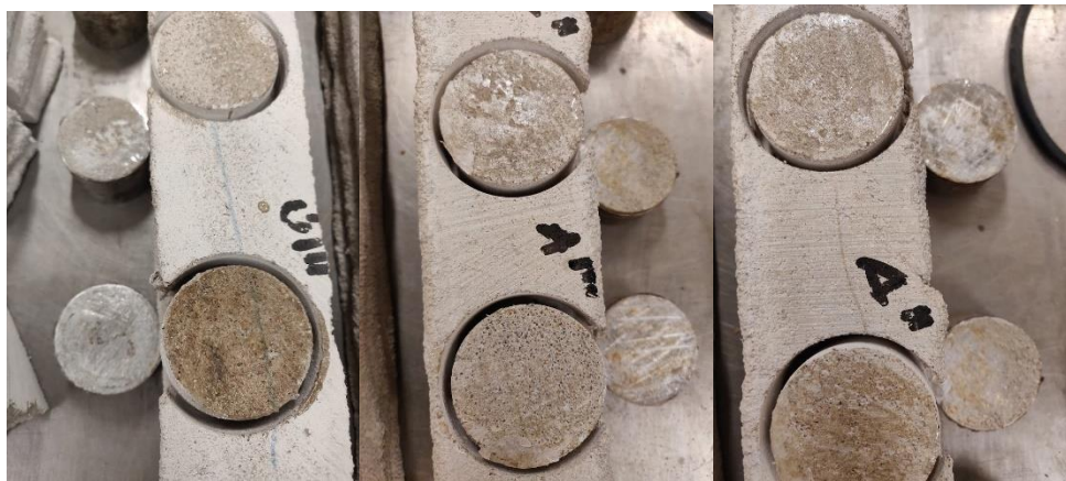
Joonis 2.21 Ebaõnnestunud väljatõmbe katse. Purunemine toimus liimi ja katsekeha vahelt.
