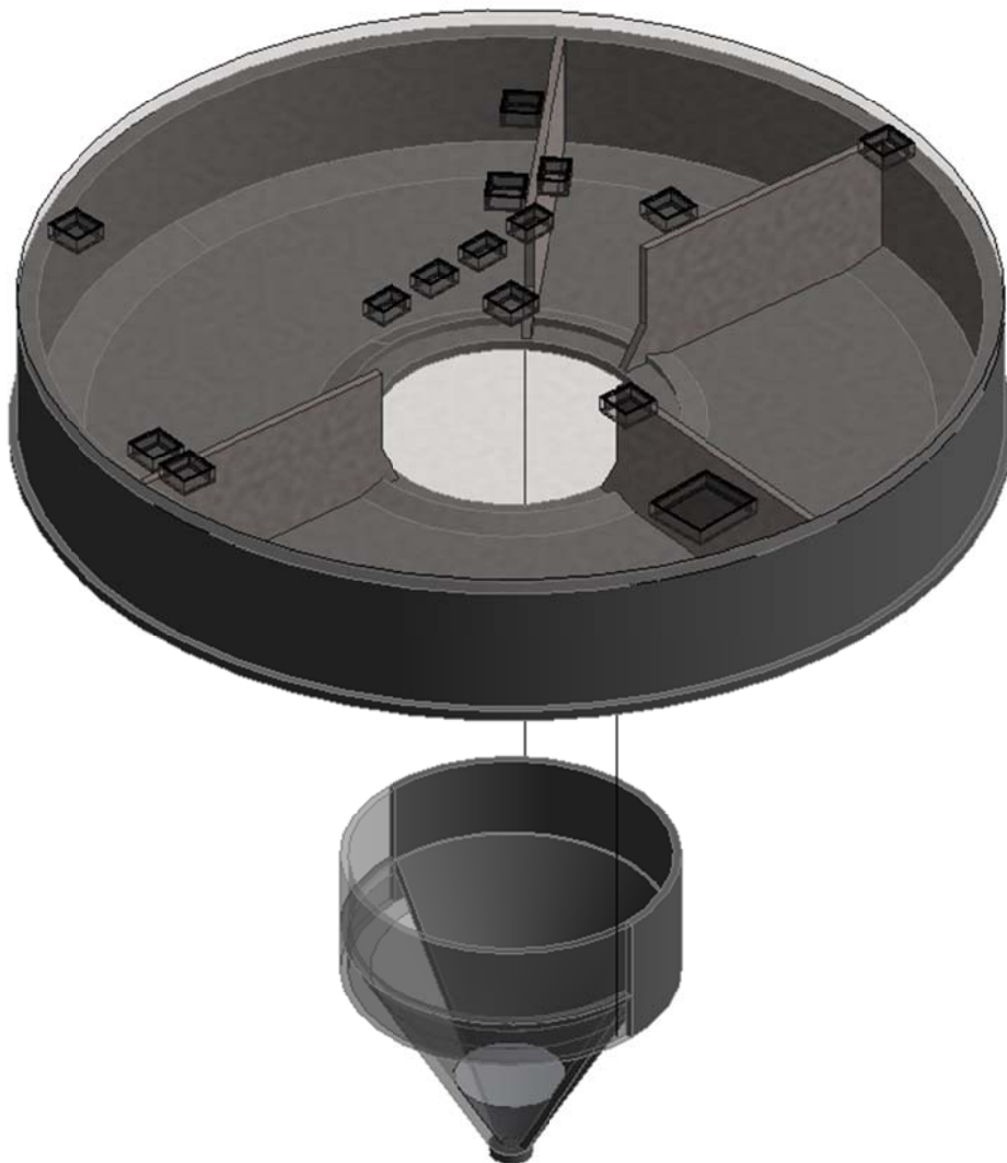
Joonis 10. Rekonstrueeritud MRP 1000 mahuti konstruktsioon.
