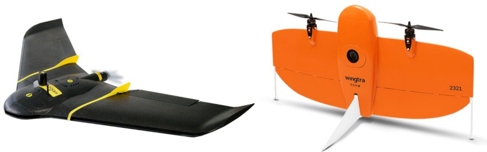
Joonis 3.11. Droonid: vasakul lennukitüüpi SenseFly 17 eBee Plus, paremal vertikaalstarti võimaldav VTOL-tüüpi WingtraOne GEN II droon 18 .
