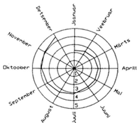
Joonis 19.32. Hoone fassaadi pragude skeem (vasakul) ja prao avanemise graafik (paremal; modif. Brait, 1965). Pragude laiused on antud millimeetrites.
