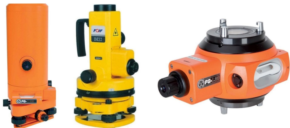
Joonis 11.4. Vertikaalviseerimise instrumendid FG-L100 (vasakul) 44 , DZJ2 (keskel) 45 ja FG-L30 (paremal) 44 .
