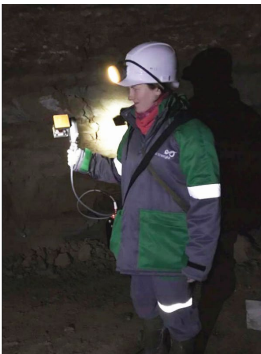
Joonis 3.8. Samaaegse kohamäära ja mõõdistamise GeoSLAM ZEB Revo RT käsiskanner 14 ning selle kasutamine kaevanduses.
