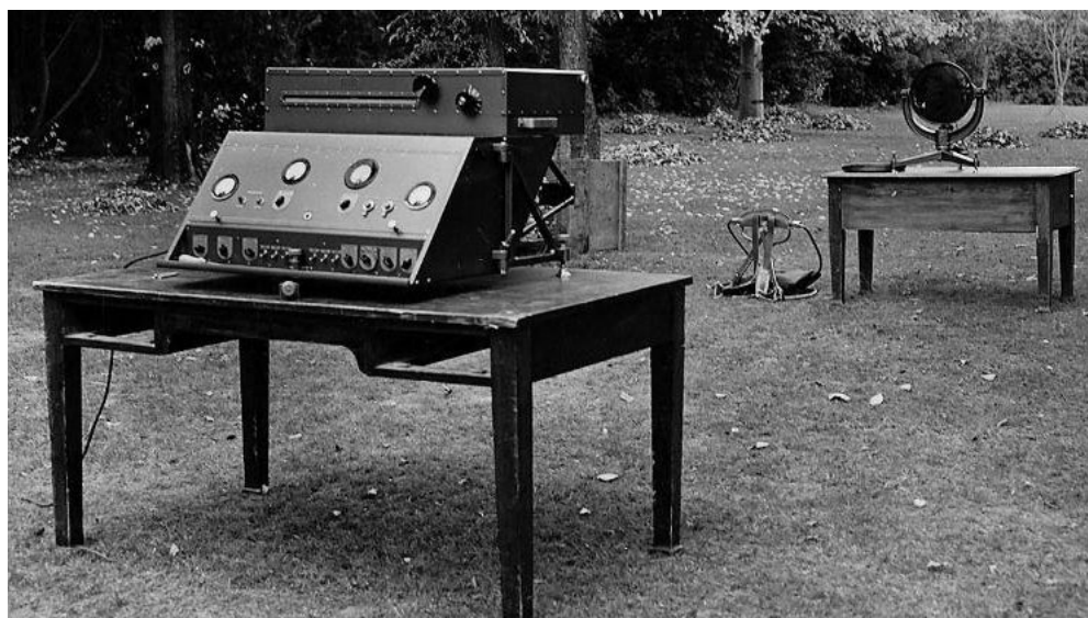
Joonis 6. Valguskaugusmõõtur 7 Geodimeter NASM-1, mis on välisuselt sarnane NASM-2-ga.
