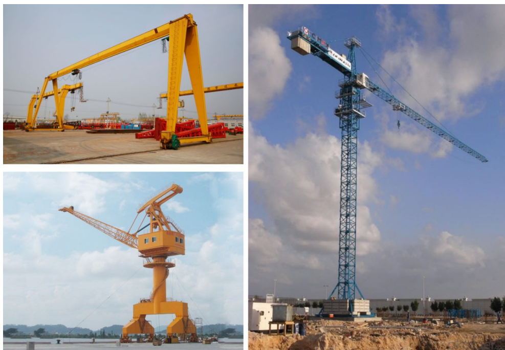
Joonis 10.3. Pukk- 39 (vasakul üleval), portaal- 40 (vasakul all) ja tornkraana 41 (paremal).
