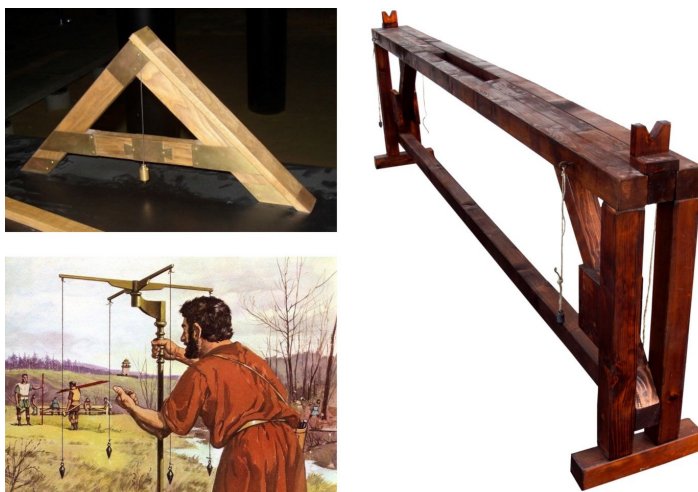
Joonis 3. Rooma riigis kasutatud lood ehk libella 3 (vasakul üleval), otse- ja ristsuuna märkimise instrument ehk groma 4 (vasakul all) ning nivelleerimisinstrument ehk chorobates 5 (paremal).
