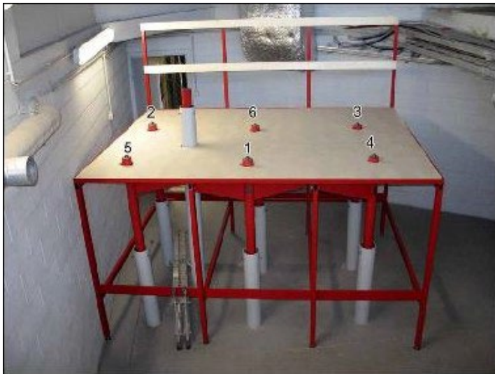
Joonis 19.6. Viru hotelli vajumisreepid (üleväl) ja reeperitekamber (all). Kuus süvareeperit oli paigaldatud eri sügavusele, et jälgida hotelli all olevate erinevate nõrkade maakihtide käitumist. Reeper nr 2 (ankur 48,15 m) ja reeper nr 1 (ankur 47,5 m sügavusel) asuvad tihedates kambriumi savides, põhireeper on nr 2. (Maa-ameti Geodeetiliste punktide andmebaas, foto A. Rüdja)
