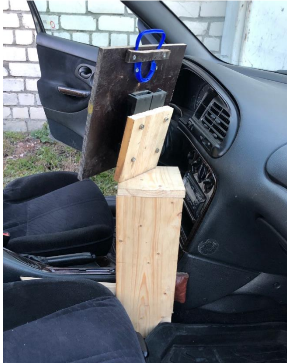
Joonis 3.18 Kiirkinniti Prototüübi katsed sõiduautos Ford Mondeo
