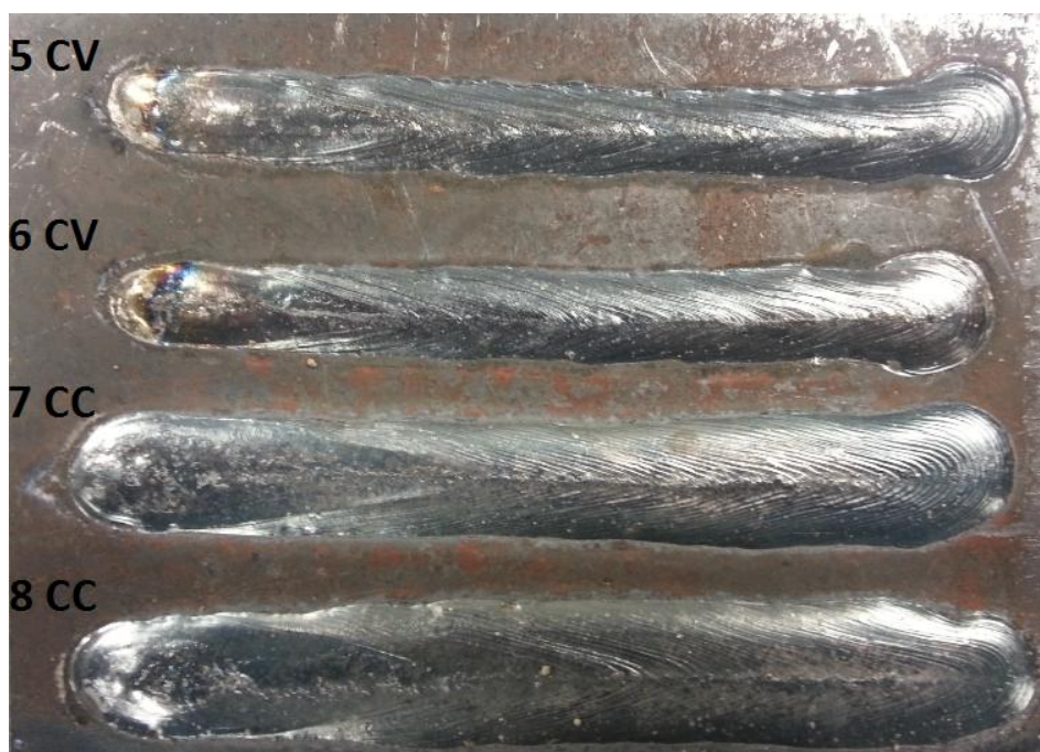
Рисунок 5.3.1. Наплавленные швы при разных режимах сварки СС/СV и изменением Уд.
