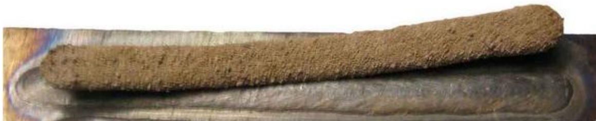
Рисунок 1.3. Сварной шов и остаток шлака [4].
