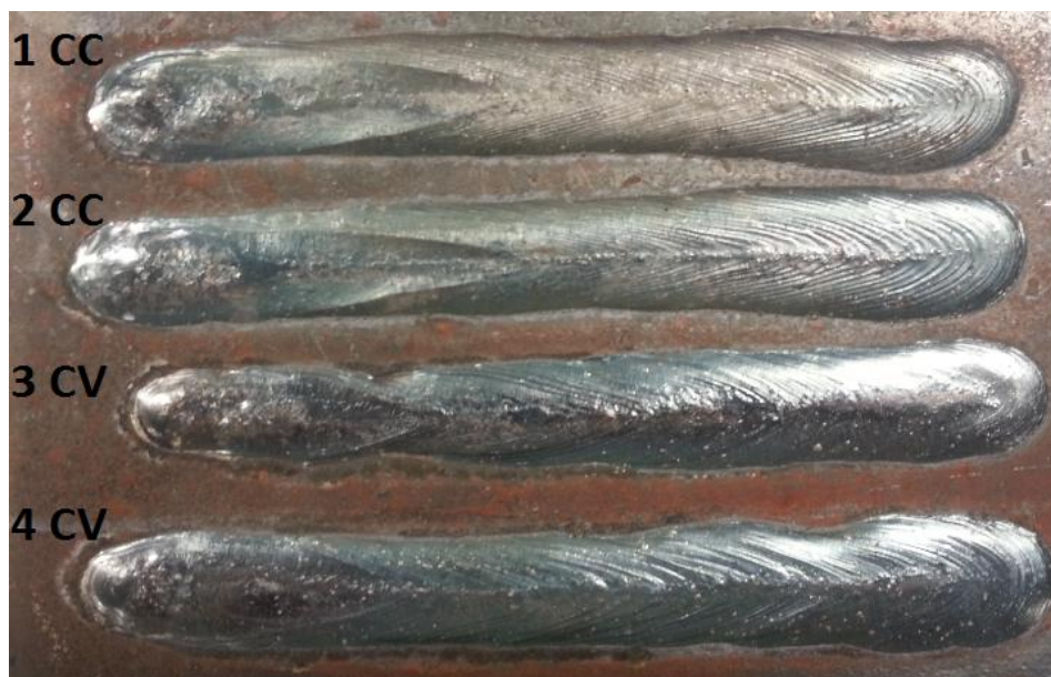
Рисунок 5.2.1. Наплавленные швы при разных режимах сварки СС/СV и изменением V_{св} .
