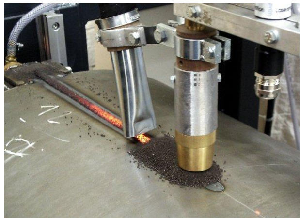
Рисунок 1.2. Процесс сварки под слоем флюса [4].
