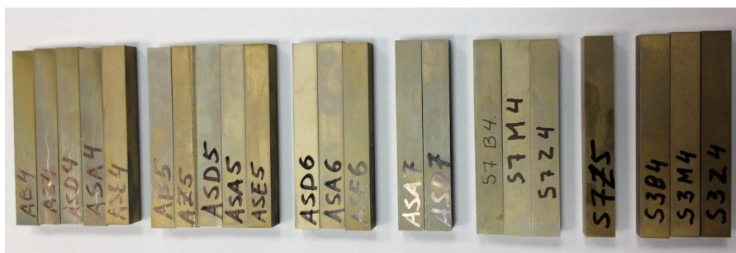
Sele 2.1 Traaterosioonis lõigatud 22 katsekeha
