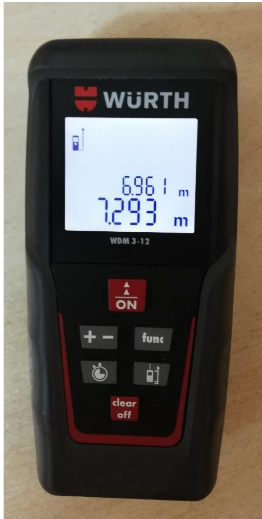
Joonis 2.7 WÜRTH WDM 3-12 mõõtetulemus lae kõrgus tehase maapinnast
