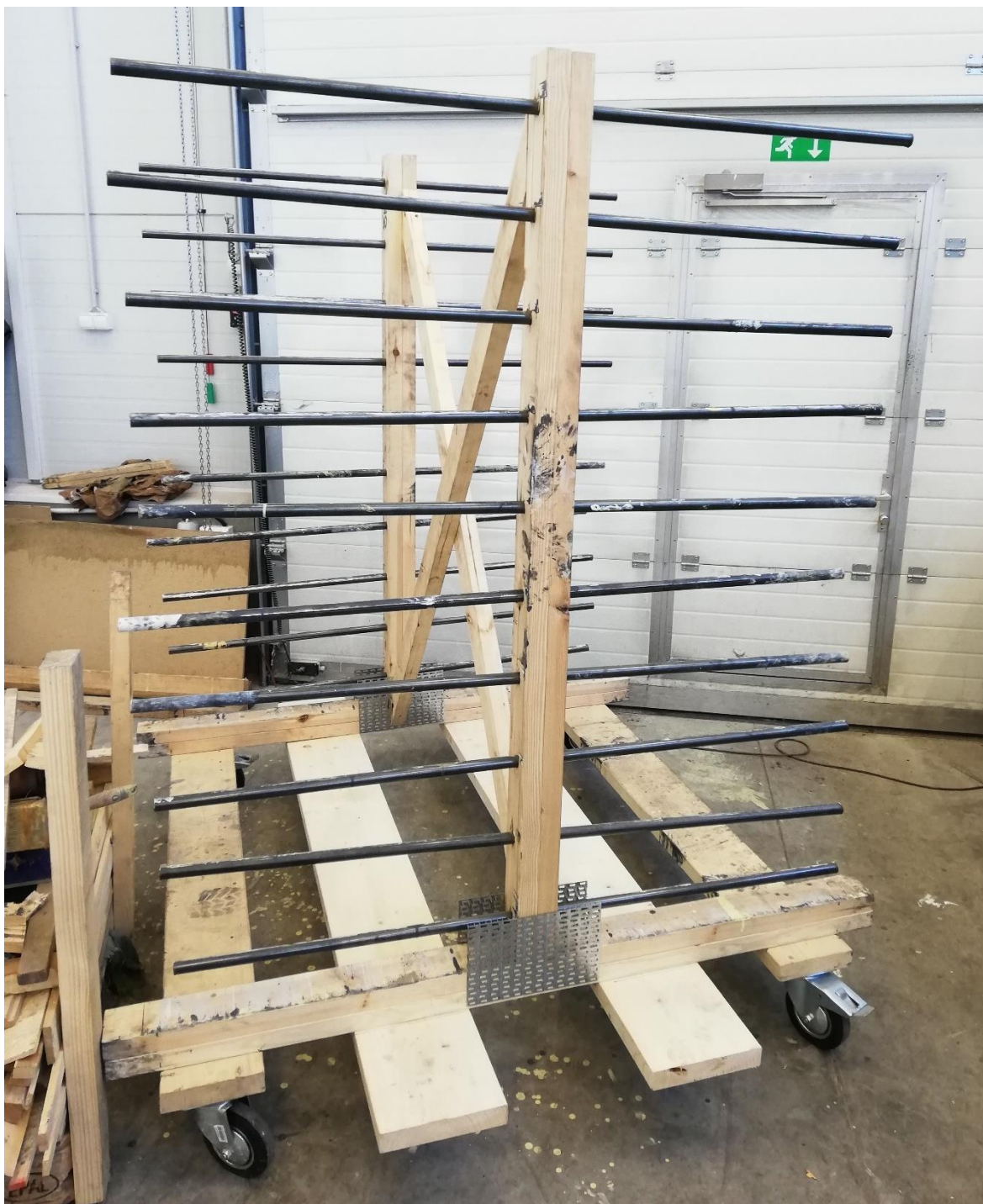
Joonis 2.8 Käsitsi valmistatud odav puidust laudise käru
