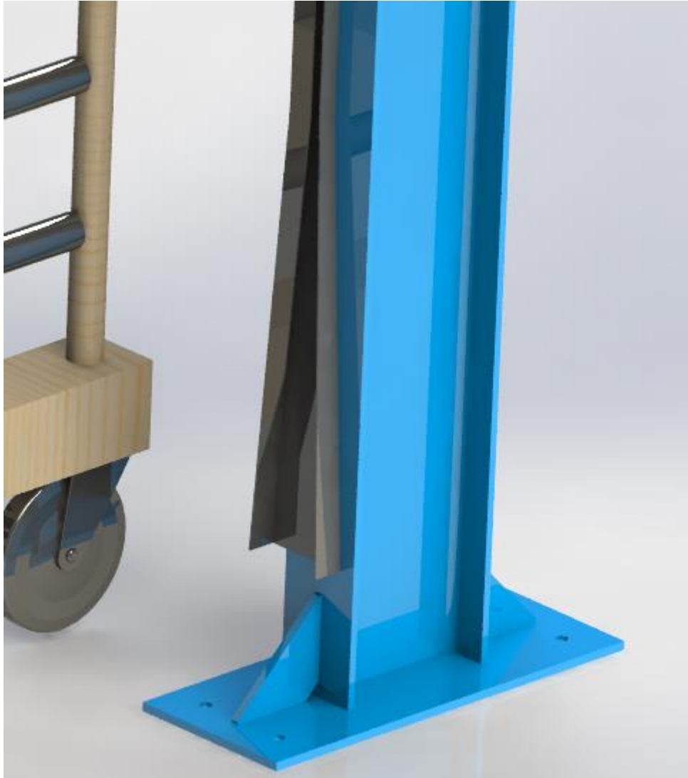
Joonis 4.18 Stabilisaatori nelikant profiil alt laienev
