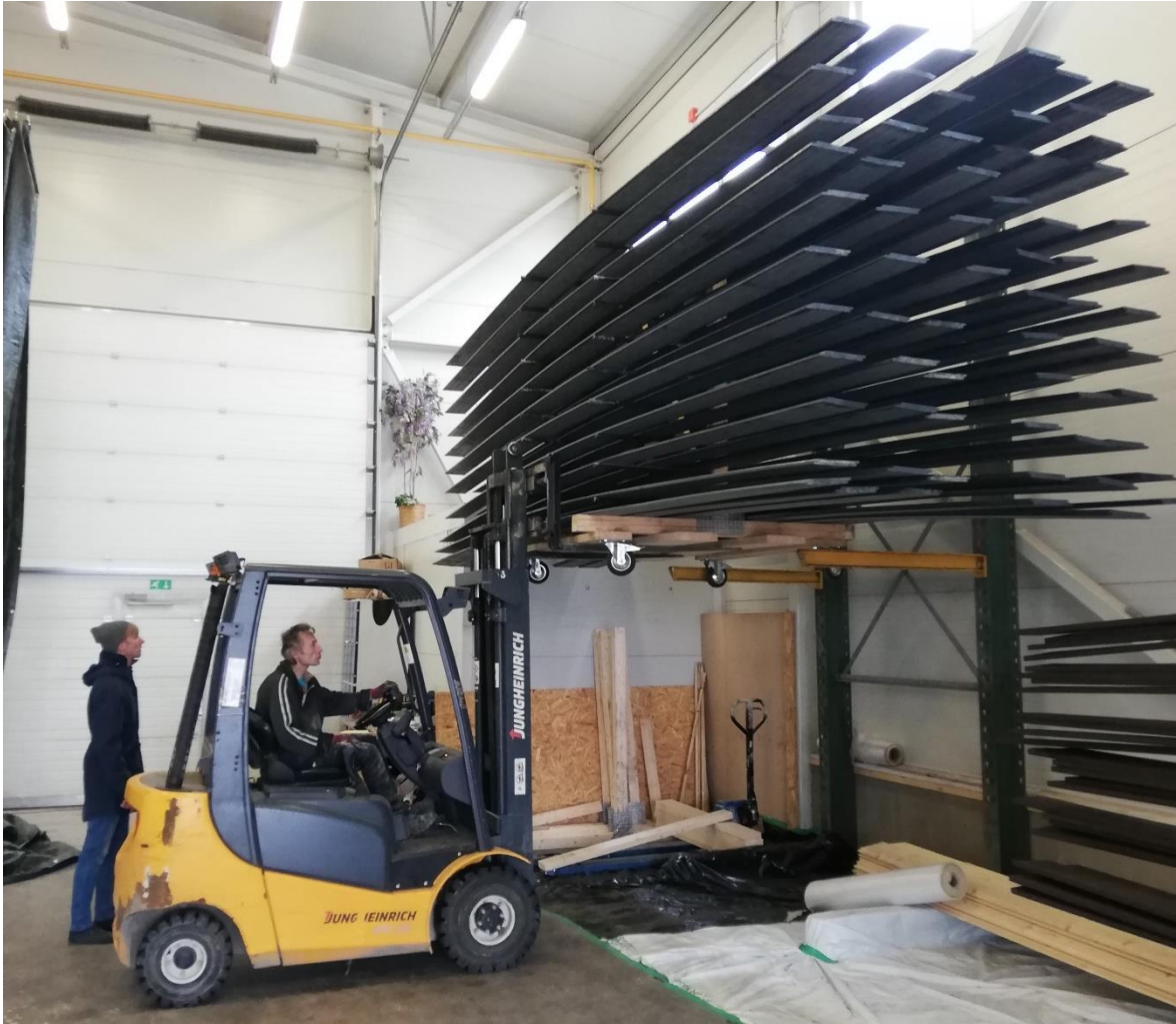
Joonis 3.18 Käru tõstmine kahveltõstukiga riiulile, mis nõuab täpset rihtimist ning hulga aega
