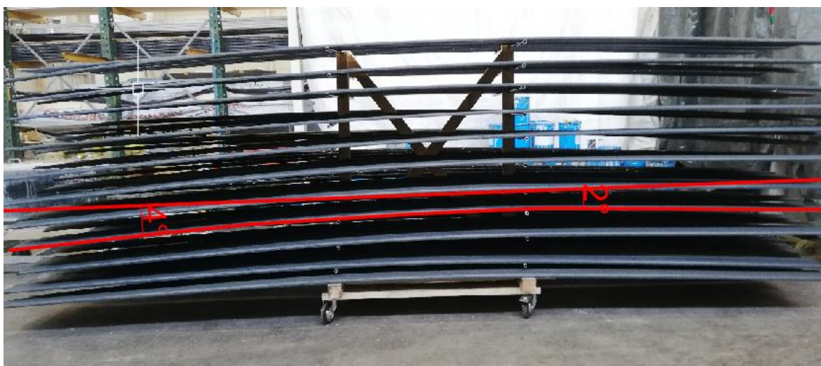
Joonis 2.14 Kärul kuivava laudise painde suurus võrreldes maapinnaga
