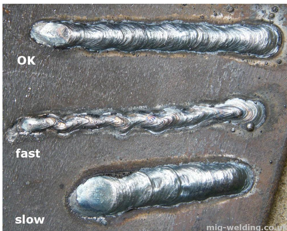
Joonis 6. Keevitamine erinevatel kiirustel (Mig-welding.co.uk)
