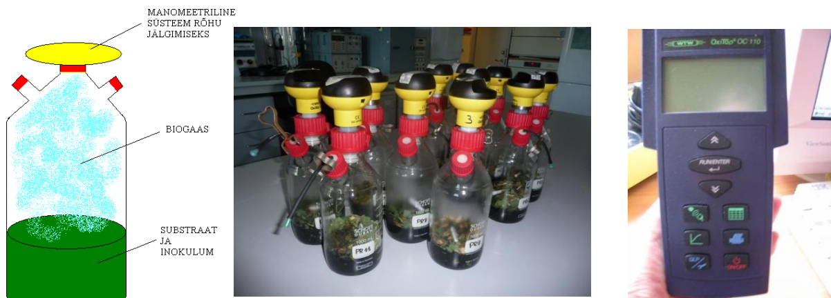
Joonis 14. OxiTop® katseseadme skeem ning fotod katsepudelitest ja andmehõiveseadmest.
