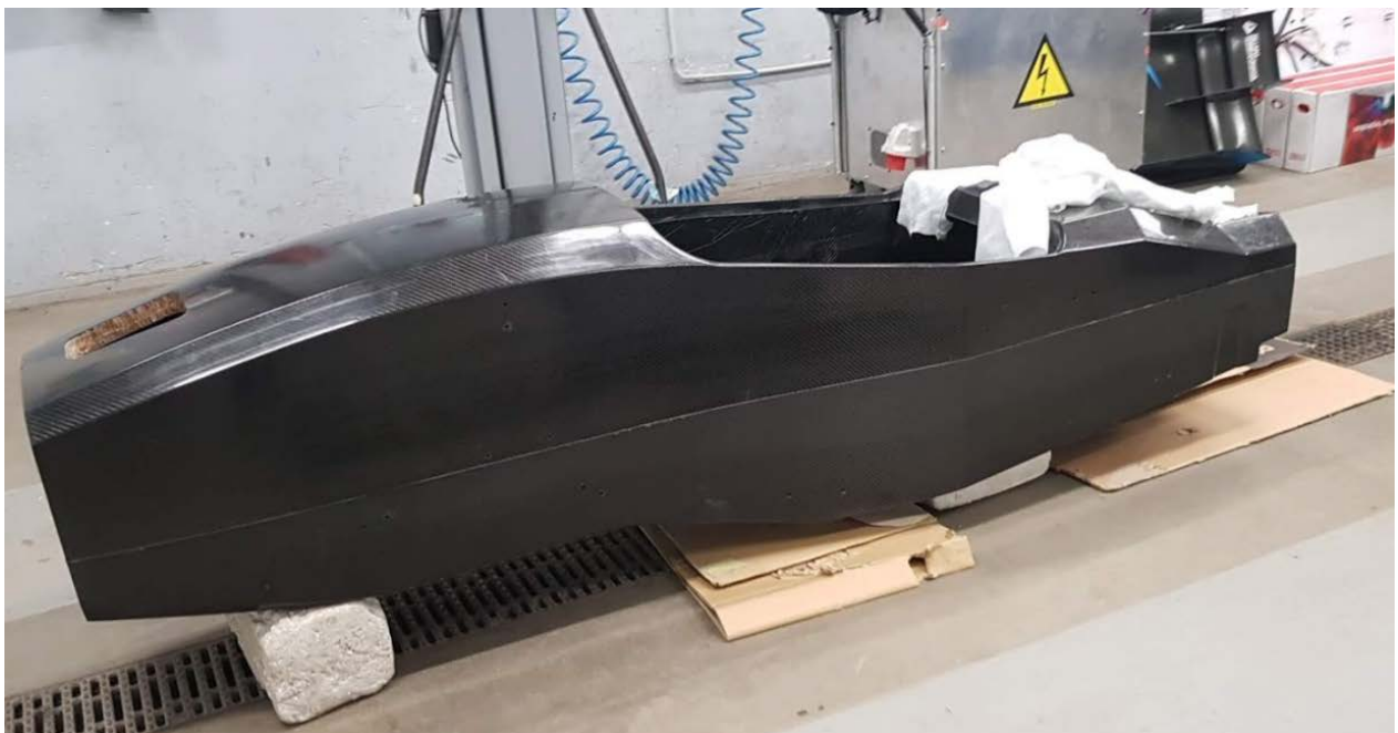
Joonis 24. FEST20 monokokk-kere toodetud kujul. Tootis komposiidimeeskond
