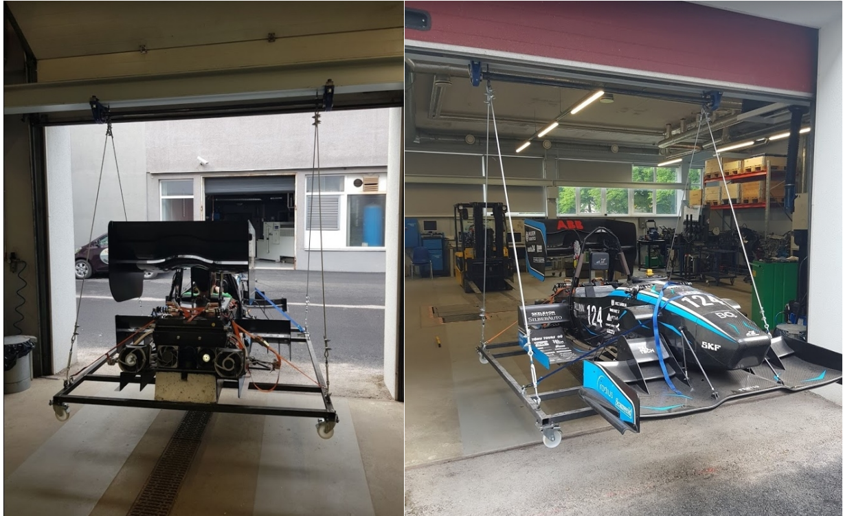
Joonis 71. Inertsmomendi mõõtmise katserakis TKTK autotehnika laboris
