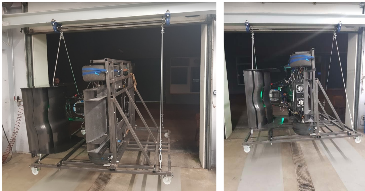
Joonis 76. FEST20 Z-telje inertsmomendi mõõtmine koos aerodünaamika paketiga
