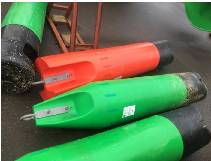
Joonis. 22. Jõetooder Mobilis ES 450 Hundipea sadamas. Foto: Melissa Kaarpalu
