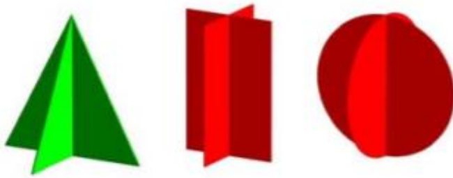
Joonis 16. Ristatud plaatidega profiilid. Allikas: (IALA Guideline 1094 2016, 12)
