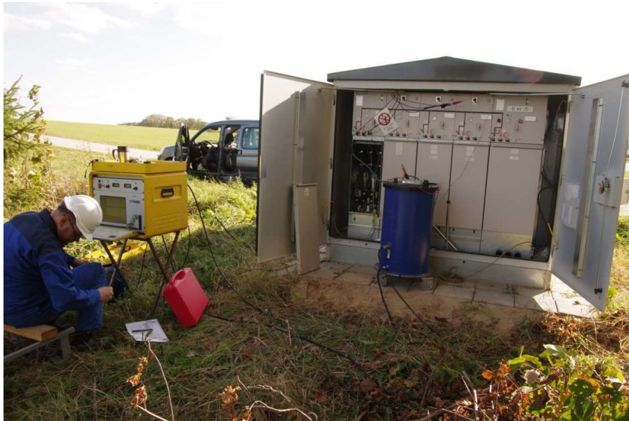
Joonis 3.3. Osalahenduste mõõtmine Navesti alajaamas [9]
