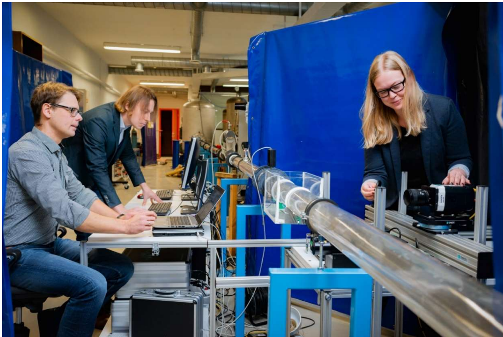
3D PIV mõõtesüsteemi kalibreerimine hüdromehaanika laboris. Vasakult paremale: N. Kändler, I. Annus, K. Kaur
