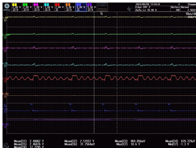
Joonis 2.3 PWM modulaatori sisendite ja väljundite väärtused ja signaali kujud
