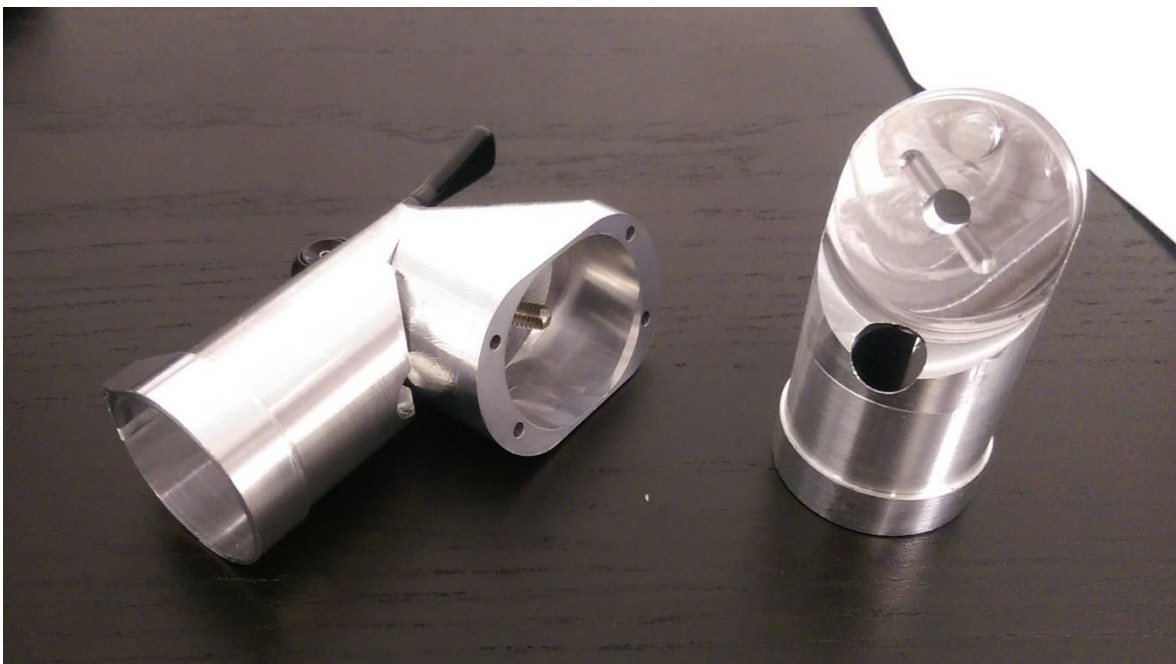
Sele 21. Tagumise parema mootoritoru kinnitus koos kerekinnitusega.
