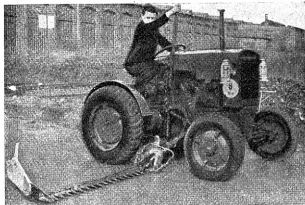
Joon. 6. 11-hobujõune väike- traktor külgemonteeritud vikatiga (Humboldt-Deutzmotoren).
