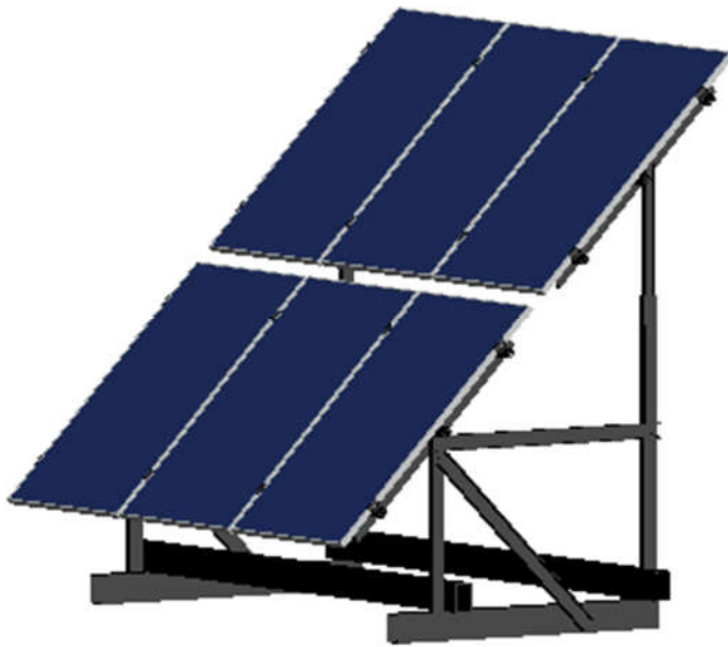
Joonis 5.8 Päikesepaneelide vertikaalne paigutus
