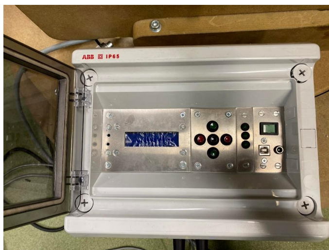
Joonis 1.4 Ilmastikukindlas kilbis olev kandeüksüsteemi juhtimisplakk
