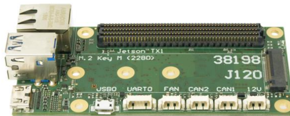
Joonis 4. Auvidea J120 laiendusplaat [4]
