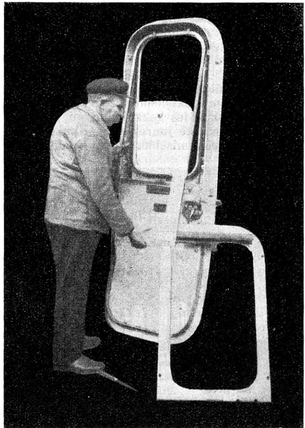
3. Vaguni välisüks alumiiniumisulatisest „Alpax“.
